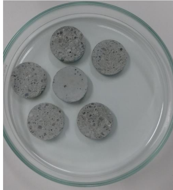
Figura 49 – Dimensão das amostras para leitura no microscópio
