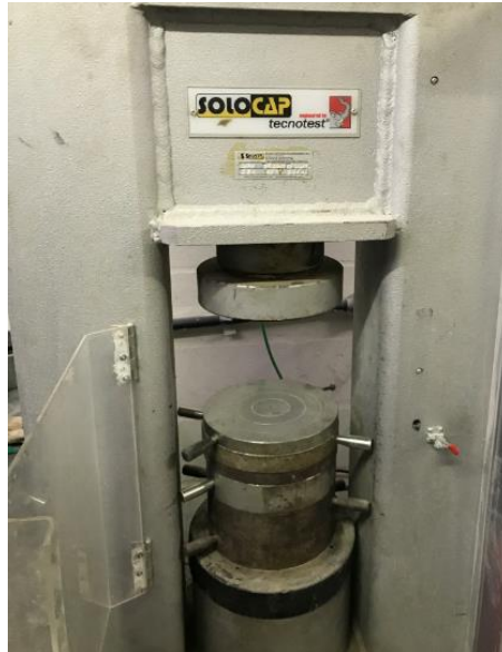
Figura 40 – Prensa utilizada no ensaio de compressão axial dos CPs
