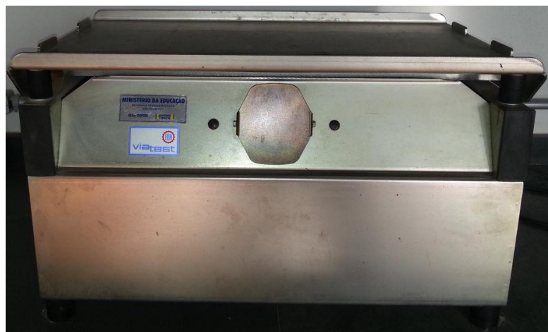
Figura 39 – Mesa vibratória para adensamento dos CPs
