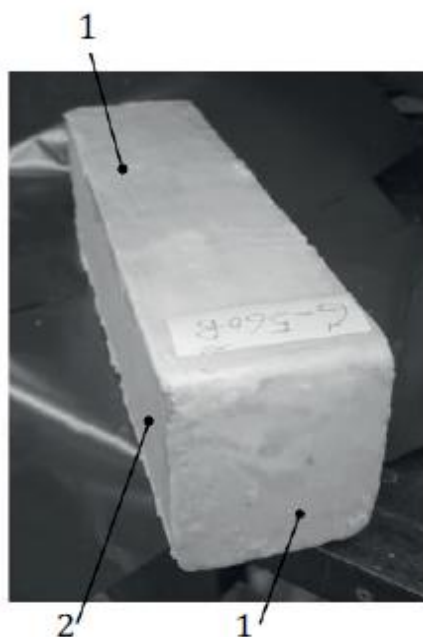
Figura 16 – Corpo de prova prismático selado em 1 e exposto em 2 Fonte: Norma ISO 1920-12 (2015), pág. 4.
