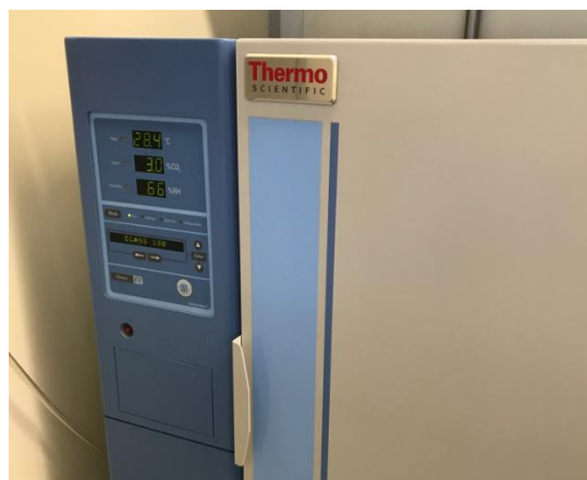
Figura 41 – Câmara de carbonatação acelerada
