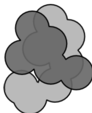
Figura 2.3: Após a sobreposição, é possível calcular a interseção volumétrica. Essa interseção é dada pelo somatório de interseções esféricas entre todos os átomos da ilha-móvel para todos os átomos da ilha-fixa.
