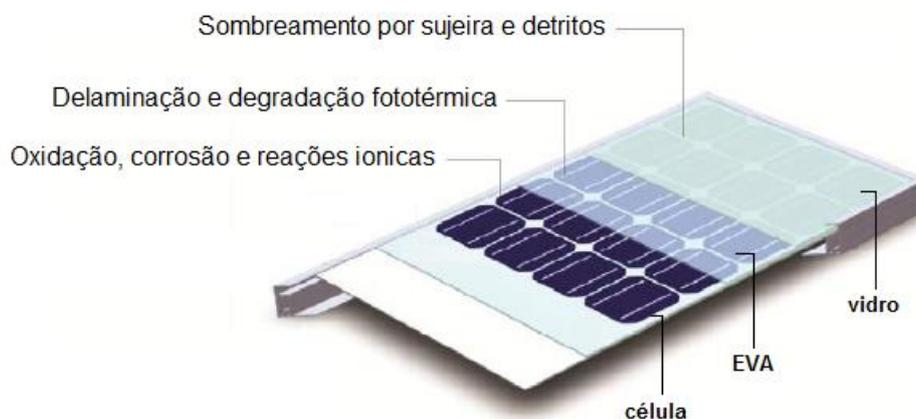
Figura 2.3 – Mecanismos de degradação nos módulos fotovoltaicos de silício. (Adaptado de: PINHO, 2014)
