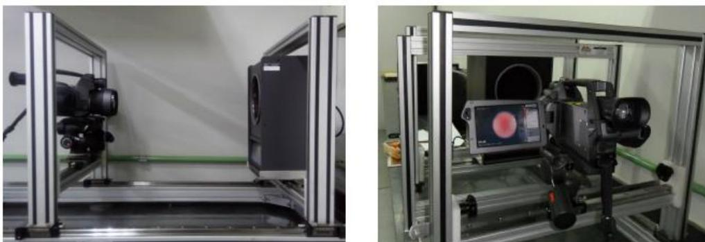
Figura 5.8 – Montagem experimental para determinação das fontes de incertezas do termovisor.
