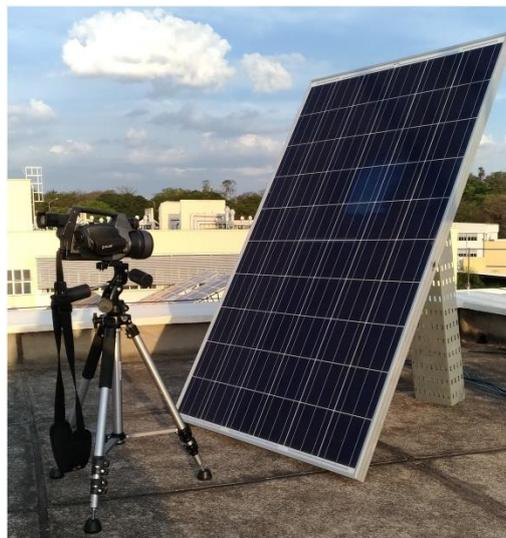
Figura 5.7 – Aparato experimental para determinação da refletividade direcional da superfície do painel.
