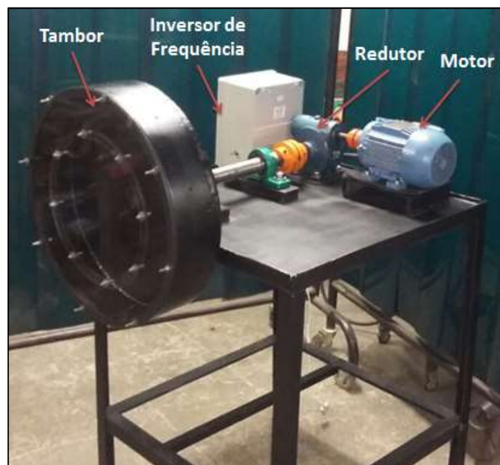
FIGURA 3.1 - Abrasômetro de tambor construído no LRSS.
