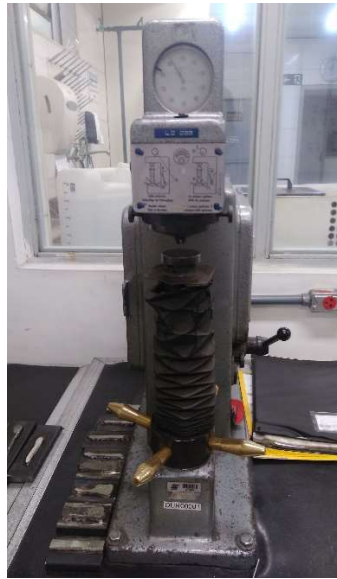
FIGURA 3.22 - Durômetro usado nos ensaios de dureza Rockwell C.
