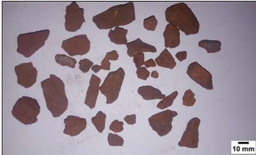
FIGURA 3.6 - Amostra de minério de ferro com granulometria selecionada entre 4,75mm e 19,00mm.
