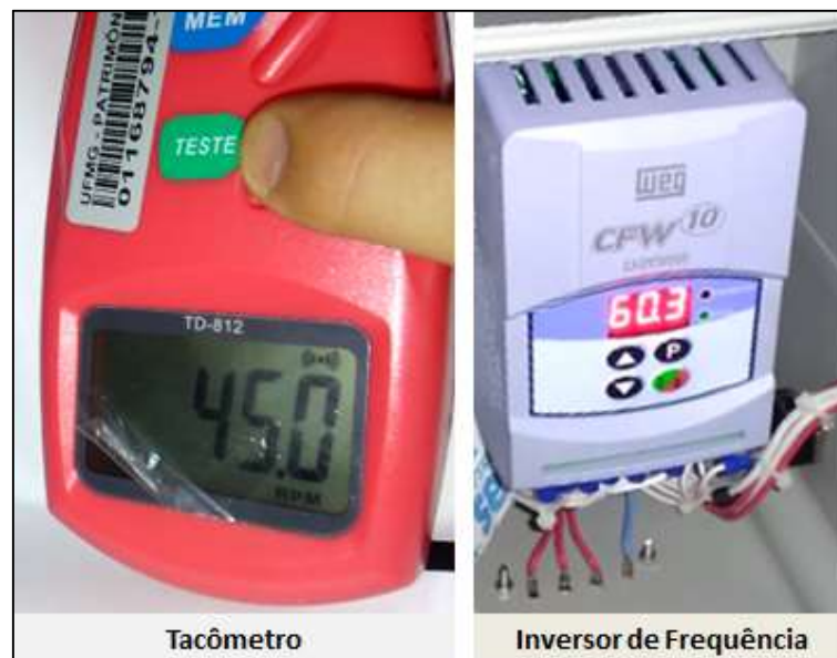
FIGURA 3.4 - Tacômetro usado na aferição da rotação do tambor e frequência correspondente.
