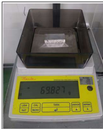
FIGURA 3.23 - Pesagem dos CP's em balança de precisão.
