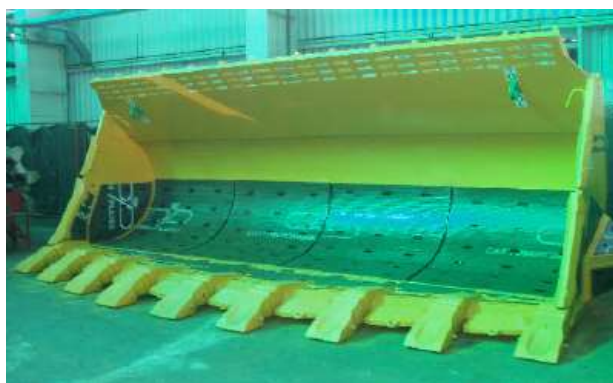
FIGURA 1.1 - Placas de proteção com revestimento duro fixadas em equipamento para movimentação de minério de ferro.
