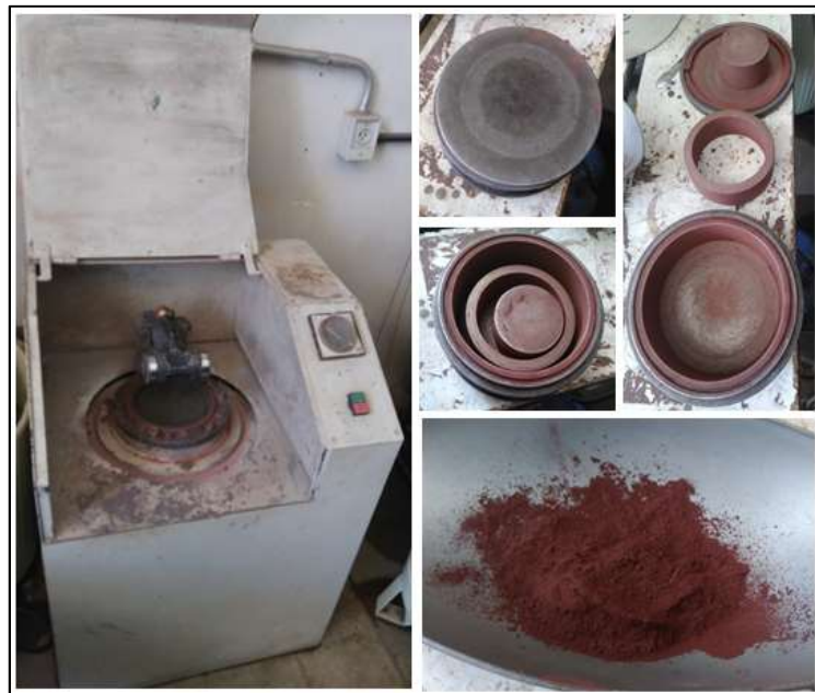
FIGURA 3.7 - Amostra de minério de ferro pulverizada para análise por DRX.
