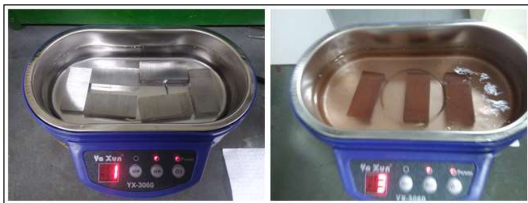
FIGURA 3.14 - Limpeza dos CP's através de banho ultrassônico.
