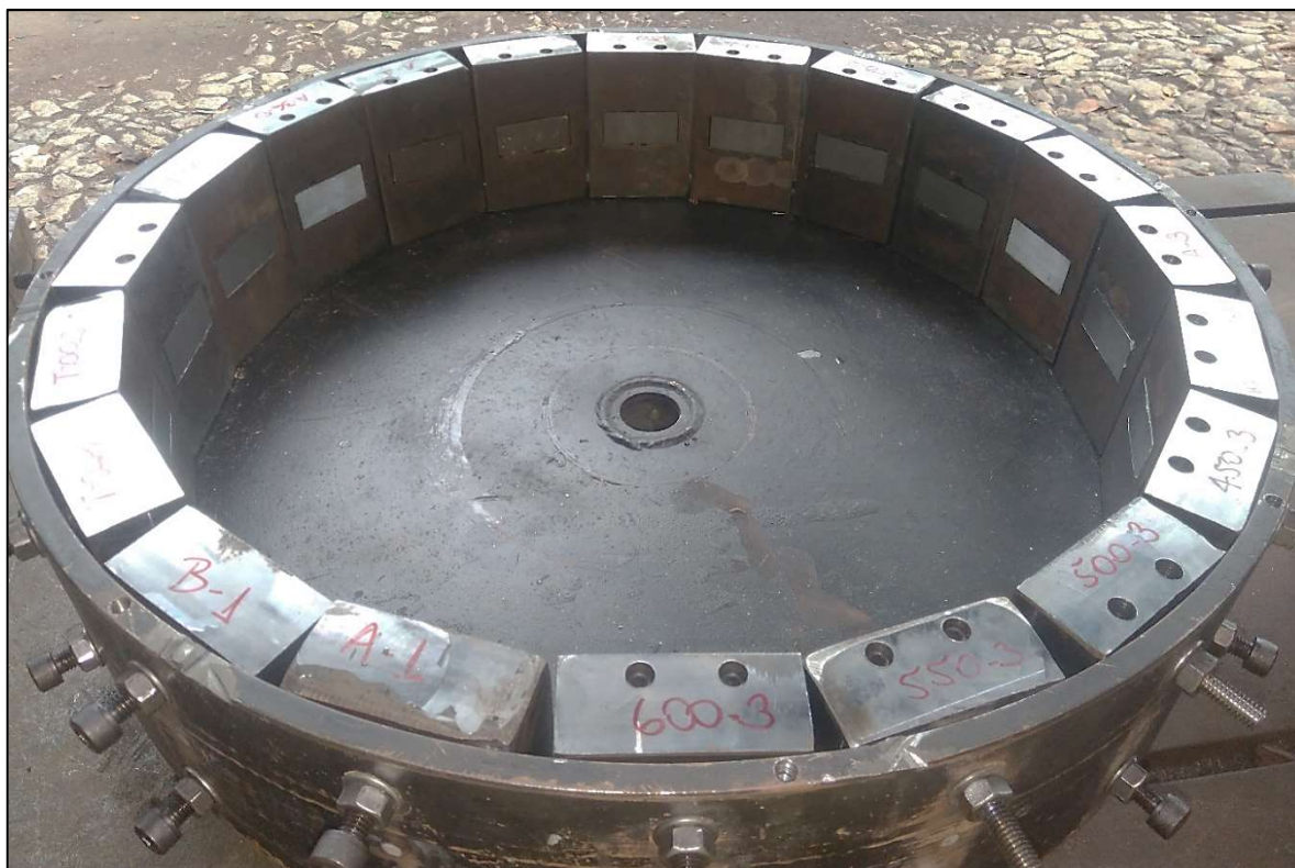
FIGURA 3.17 - Tambor pronto para o ensaio, com os porta amostras posicionados e os corpos de prova em seu interior.
