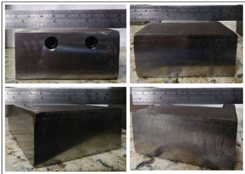
FIGURA 3.15 - Verificação do alinhamento do cp com o porta amostra.
