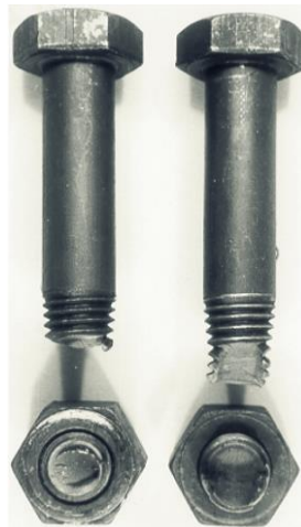
Figura 3.3 – Comparação entre os dois modos de falha: tração por torque da porca no parafuso à esquerda e tração direta no parafuso à direita. Fonte: Kulak et al. (1987)
