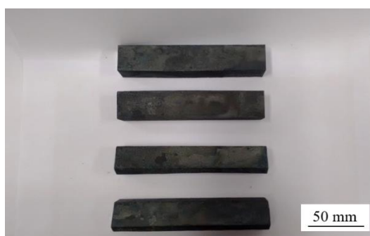
Figura 4.4 - Material seccionado submetido a tratamento térmico de homogeneização.
