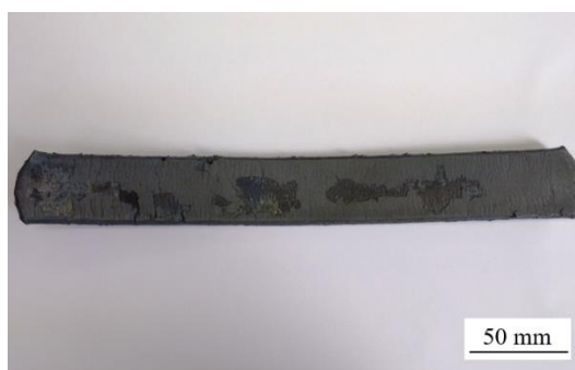
Figura 4.6 - Exemplo de placa do aço 8Mn laminada a quente.
