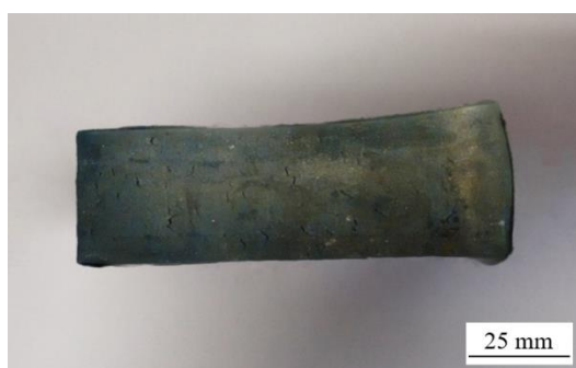
Figura 4.9 - Exemplo de placa do aço 0,08C-8Mn laminado a morno.
