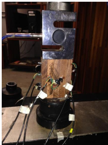
Figura 4.12 – Ensaio de compressão nas amostras menores.
