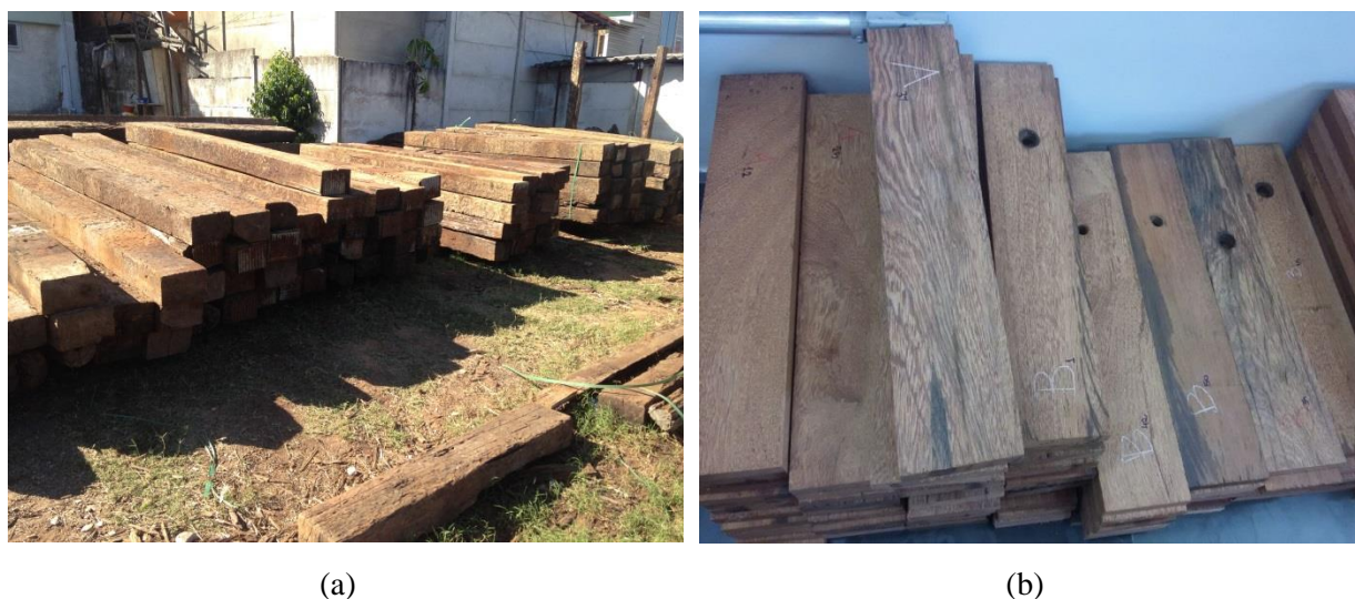
Figura 4.1 – Material utilizado na pesquisa. (a) Dormentes tipo mourão e (b) Tábuas oriundas do desdobro.
