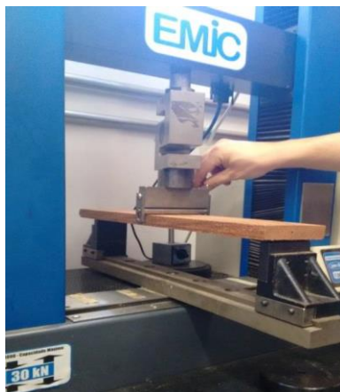
Figura 4.4 – Ensaio de Flexão “semi” destrutivo.
