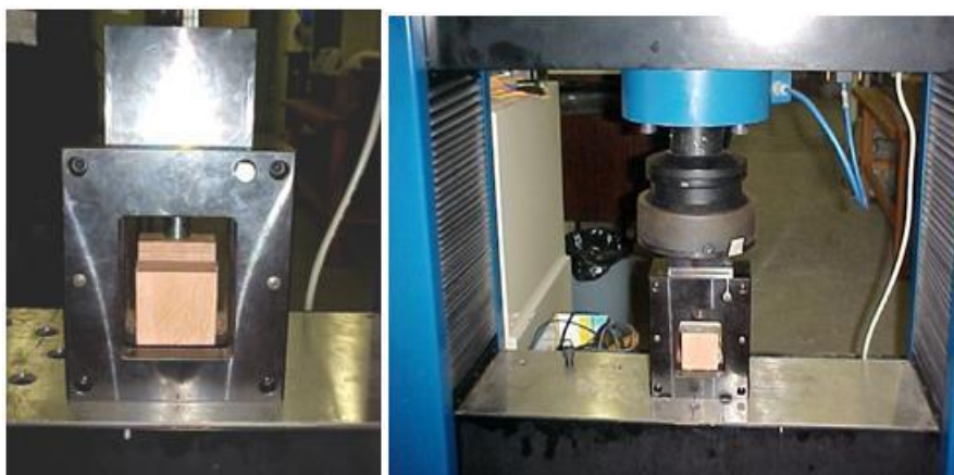
Figura 4.7 – Suporte e ensaio de cisalhamento da linha de cola.
