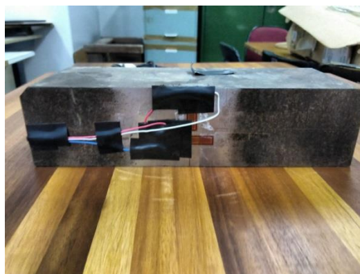
Figura 4.10 – Célula de carga desenvolvida para o ensaio nas placas.
