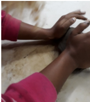
Figura 28 - Figuras de 28 à 31– Processo de forma correta de manuseio (amassar) a cerâmica, Fotos: Elô Rossoni
