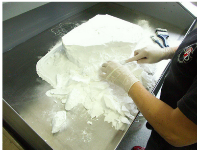
Figura 6 - - Impressão 3D pelo método da SLS
