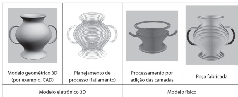
Figura 1 – Representação das etapas de um processo de impressão 3D
