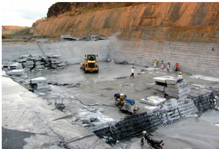
Figura 2 – Frente de lavra de ardósia cinza, com destaque para a regularidade e horizontalidade do piso. FEAM (2014)
