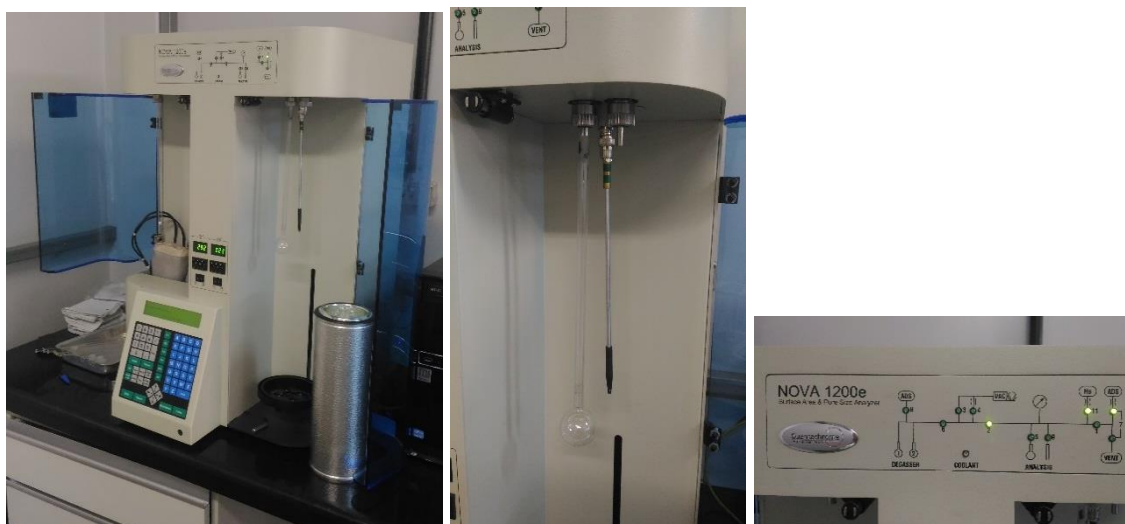
Figura 25 – Equipamento NOVA 1200e Surface Area & Pore Size Analyzer – Quantachrome Instruments. Fonte: Autor (2017)
