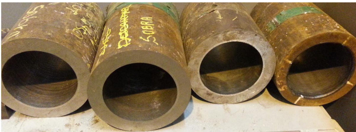
Figura 9 – Tubos API 5L X70 utilizados na qualificação do procedimento de soldagem, após revestimento interno com Inconel 625
