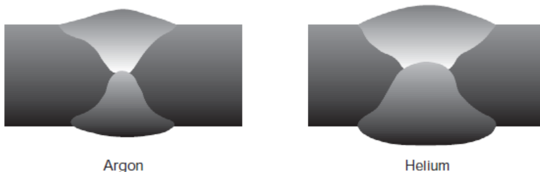
Figura 10 – Efeito dos gases de proteção argônio e hélio no perfil da solda
