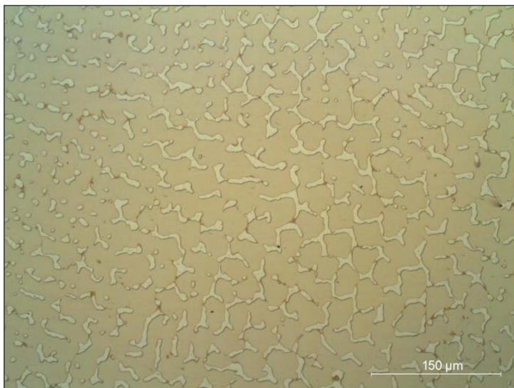
Figura 28 – Aspecto microestrutural no metal de solda (raiz) – Ataque de Nital 5%
