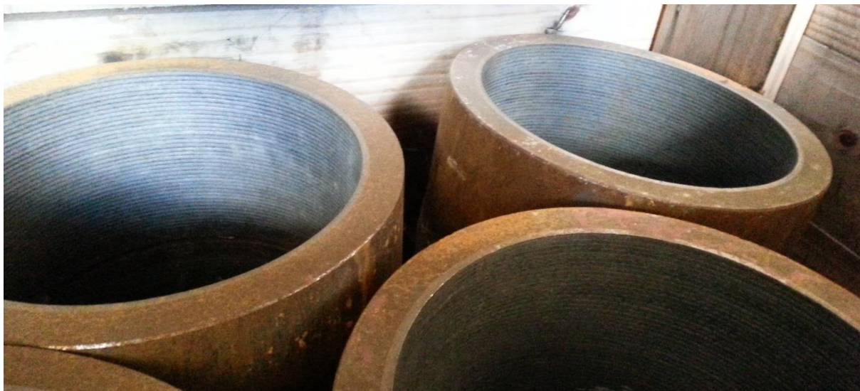
Figura 6 – Tubos de aço API 5L X70 revestidos internamente pelo processo GTAW Hot Wire
