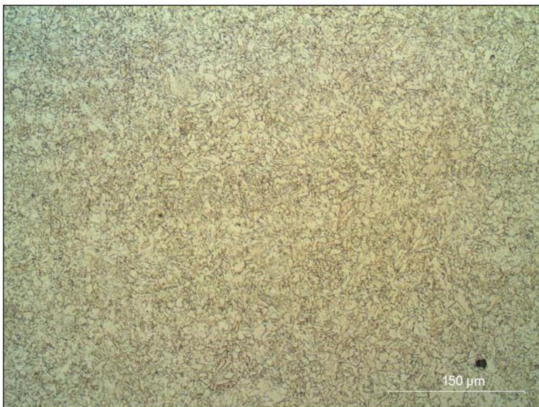
Figura 24 – Aspecto microestrutural do metal base – Ataque de Nital 2%
