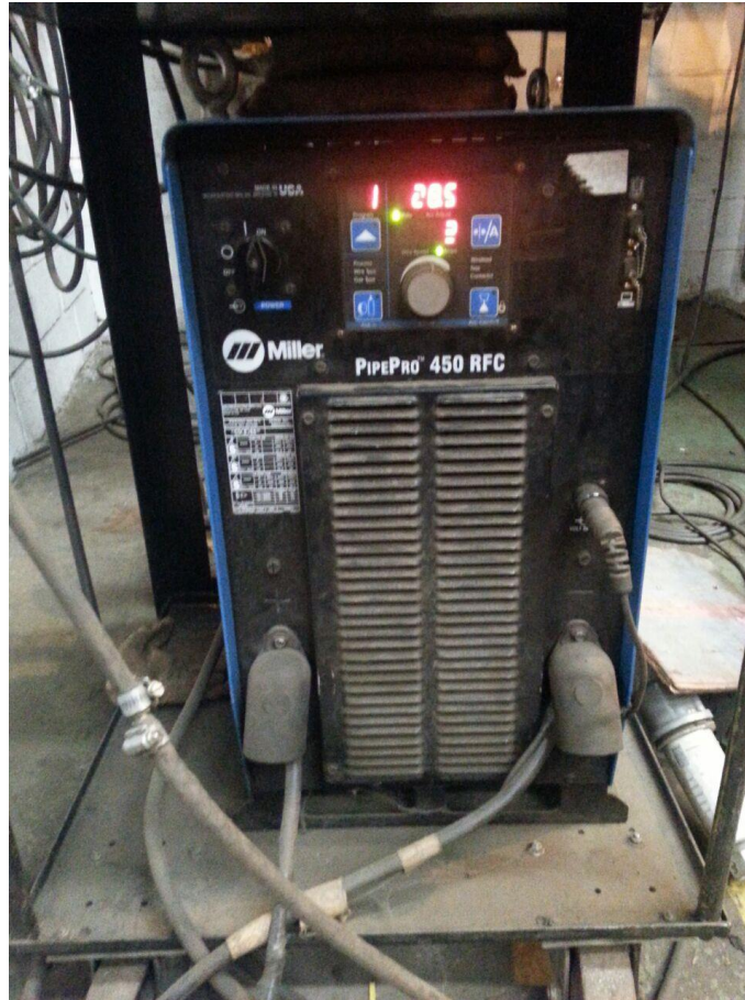
Figura 11 – Fonte de soldagem Miller PipePro 450 RFC
