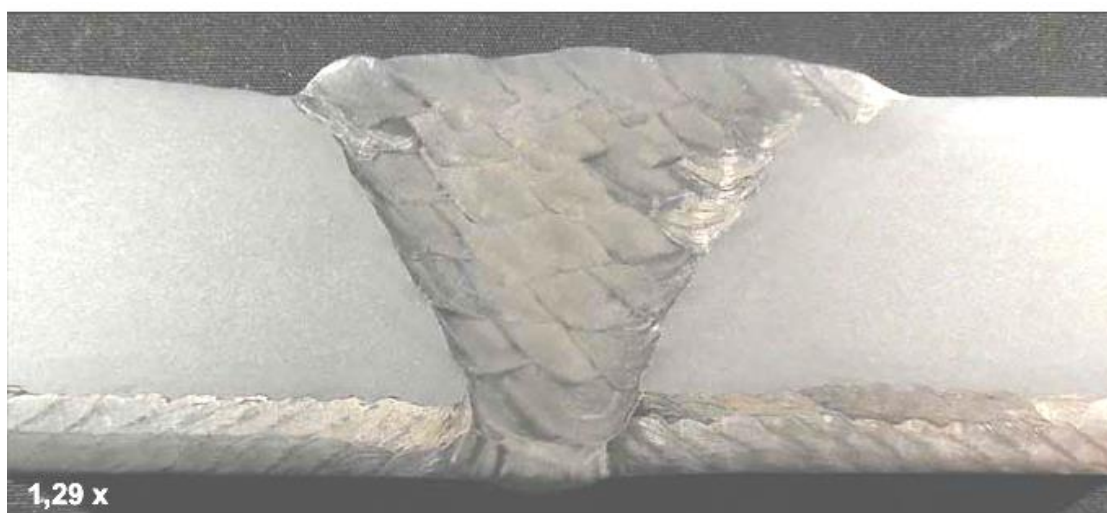
Figura 22 – Aspecto macrográfico da junta soldada CP1 – Ataque de Nital 5%
