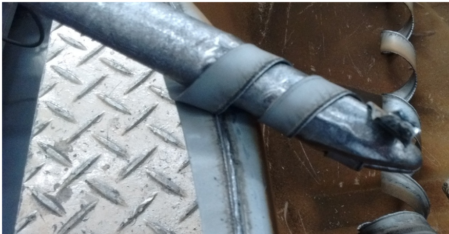
Figura 17: Foto exemplificando o ensaio de arrancamento na solda costura
