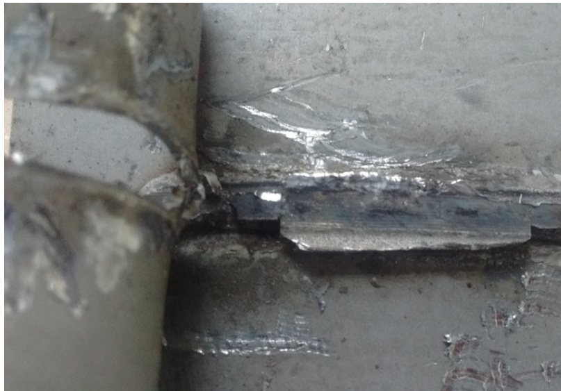
Figura 22: Resultado do teste de arrancamento do corpo de prova com solda costura
