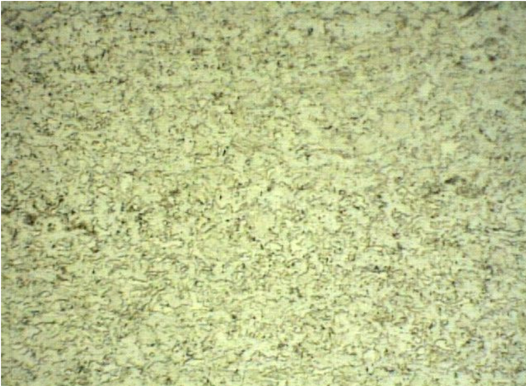
Figura 24: Microestrutura do metal base, observada com aumento de 1000 X (ataque Nital 3%).
