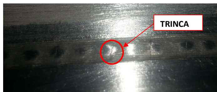
Figura 20: Foto da visualização da trinca na solda costura no aço TRIP DP 780.
