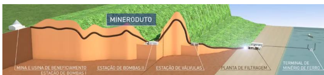
Figura 10 - Esquema do mineroduto
