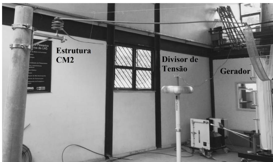
Figura 4.7 – Arranjo para a realização dos ensaios. Adaptada de (SOUZA; GOMES; et al., 2017).
