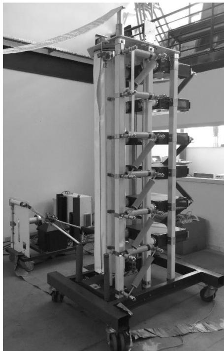
Figura 4.8 – Gerador de tensões impulsivas modelo Haefely SGSA 600kV 30 kJ.
