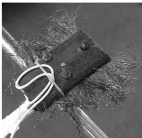
Figura 5.2 – Escova metálica utilizada para a remoção da carga depositada sobre a cobertura do cabo.
