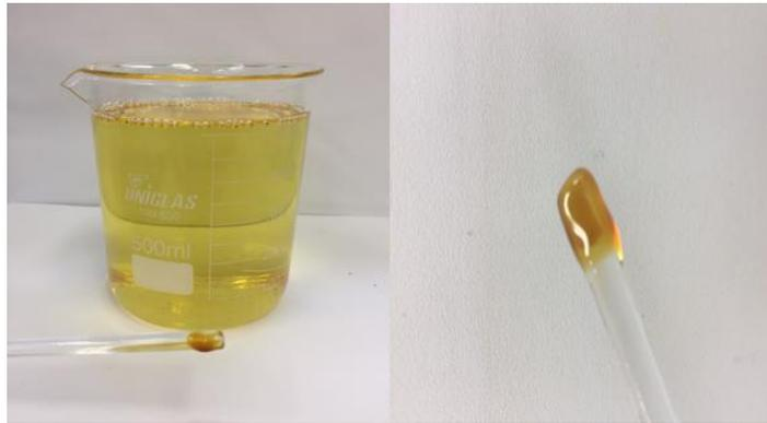
Figura 23 – Filme viscoso formado no fundo dos recipientes com B20 de soja no tempo  $t_6$ .
