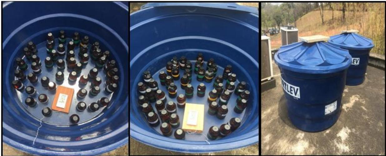
Figura 14 - Armazenamento das amostras durante o envelhecimento natural.
