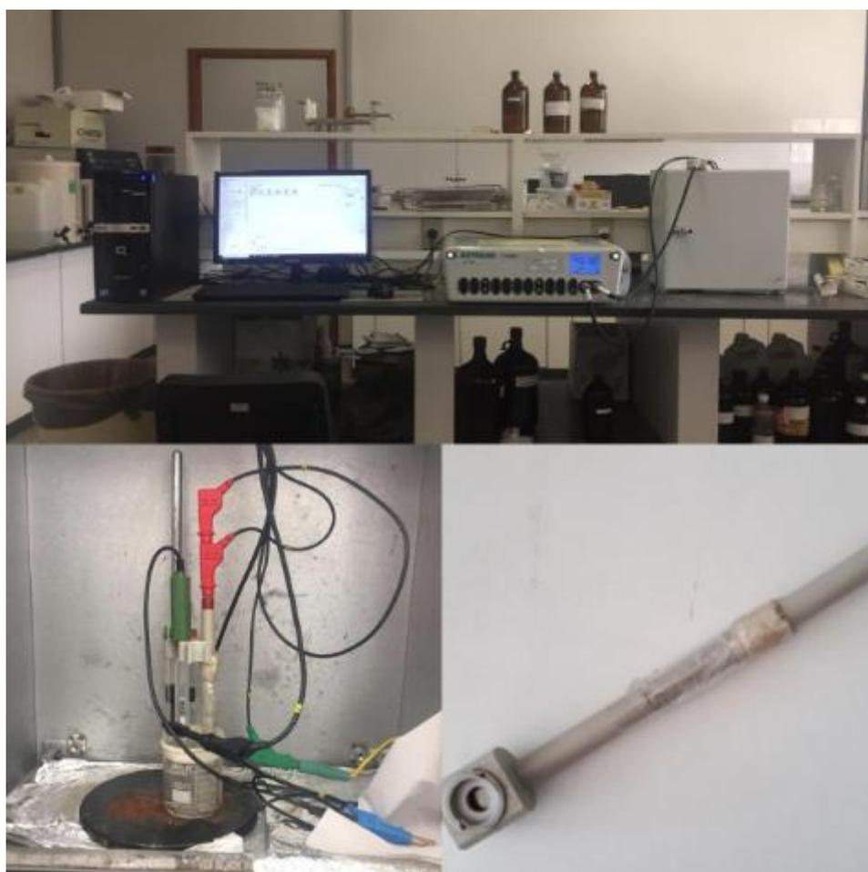
Figura 9 – Potenciostato/galvanostato, célula eletroquímica e cachimbo utilizado no teste de impedância.
