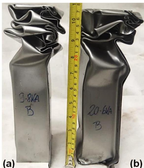
FIGURA 4.26 – Compressão: (a) 9ciclos/8kA; (b) 20ciclos/6kA.
