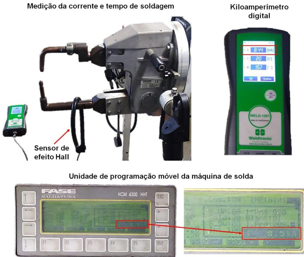
FIGURA 3.4 – Calibração da corrente e tempo de soldagem da máquina de soldagem.
