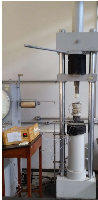
FIGURA 4.5 - Montagem final na máquina de tração e compressão Kratos.
