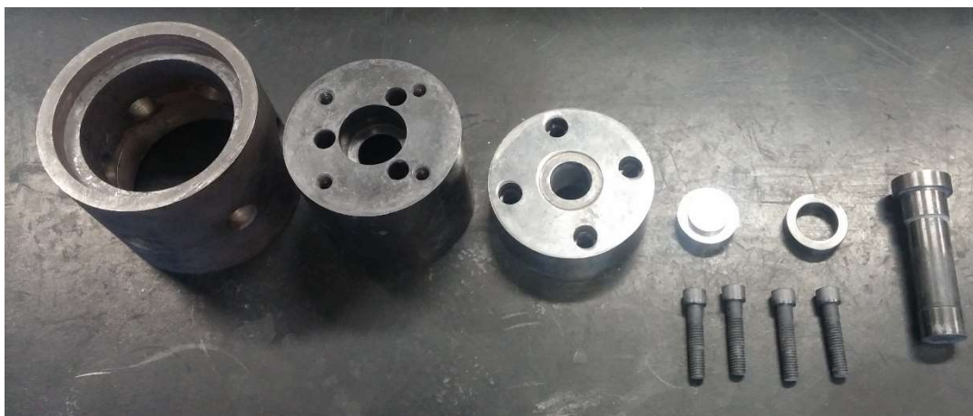
FIGURA 4.3 – Montagem da matriz de extrusão na máquina de tração e compressão Kratos.
