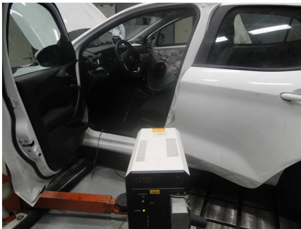
Figura 4.12: Mapeamento do diafragma do alto-falante por meio de um vibrômetro laser de efeito Doppler (autor 2018).
