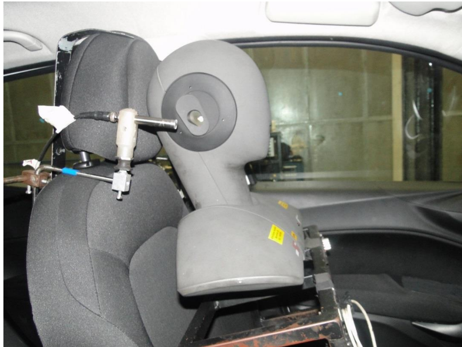
Figura 5.6: Experimento para a caracterização do sistema de som do veículo padrão (autor, 2018).
