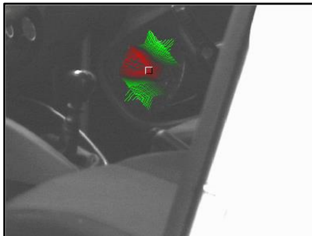
Figura 4.14: Padrão de deslocamento do cone em 2.000 Hz (autor, 2018).
