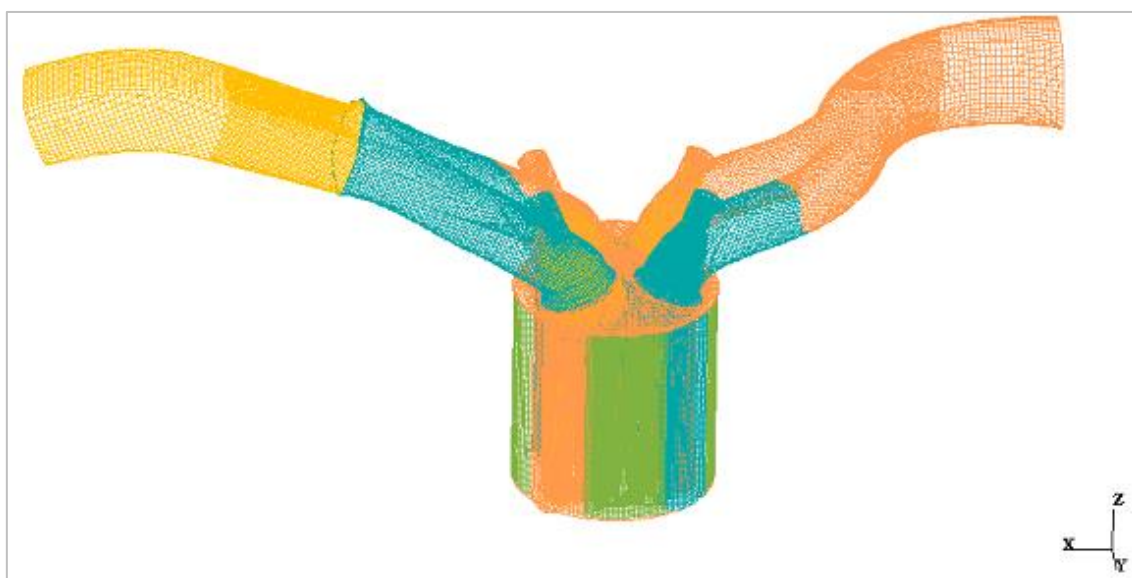
Figura 25 - Malha da parte interna do motor e coletores de admissão e exaustão
