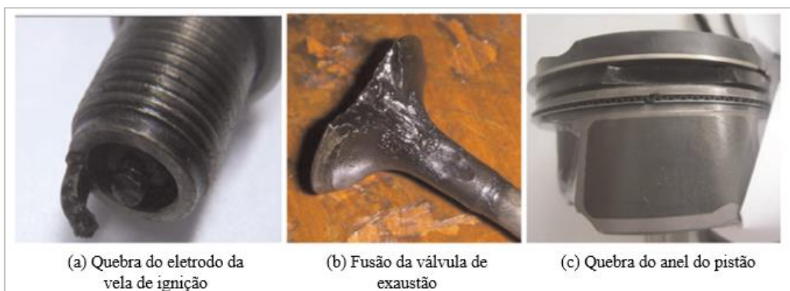
Figura 7 - Exemplos de danos aos componentes do motor devido à detonação de alta intensidade
