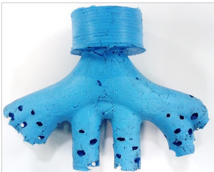
Figura 22 - Molde de silicone obtido para a geometria interna do coletor de exaustão
