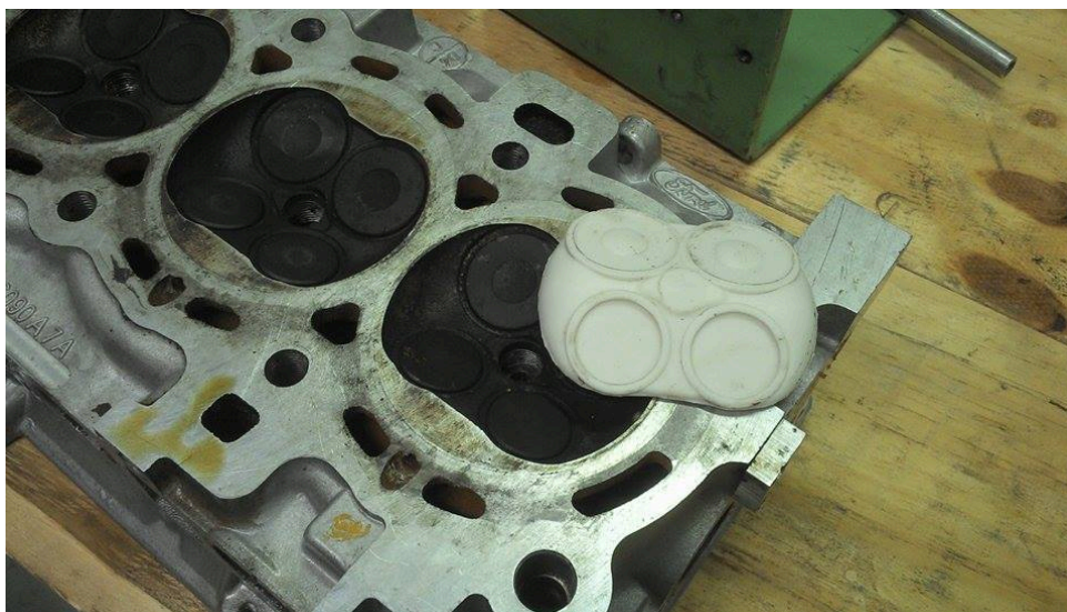
Figura 3.3 – Silicone retirado do cabeçote do motor para modelar a geometria interna da câmara de combustão
