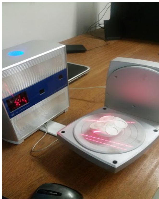
Figura 3.7 – Montagem do silicone no Scanner 3D
