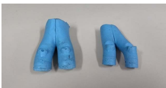
Figura 3.5 – Silicone para extração da geometria dos pórticos
