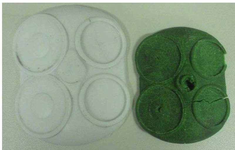
Figura 3.4 – Diferença entre silicone e massa de modelar para obtenção da geometria da câmara de combustão
