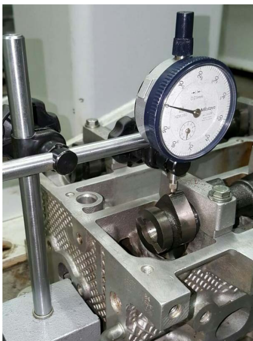
Figura 3.22 – Relógio comparador montado no came para obter o perfil do came
