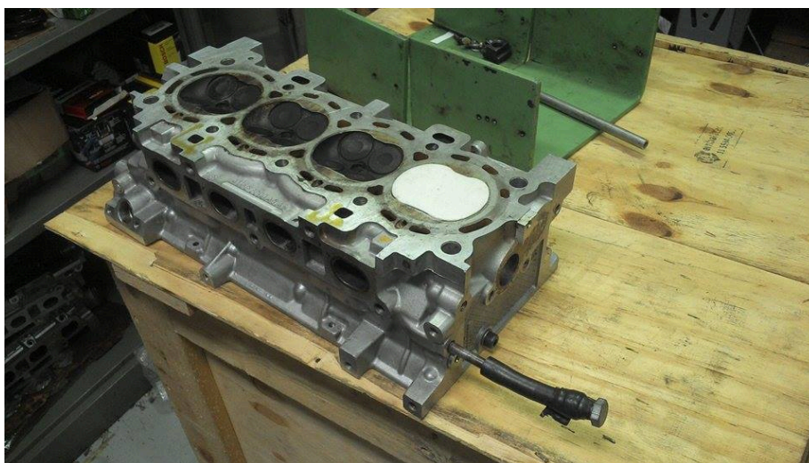
Figura 3.2 – Silicone inserido no cabeçote do motor para obtenção da geometria interna
