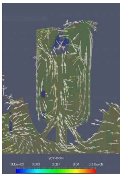
Figura 4.11 - Campo de velocidade no plano a 45^\circ do plano y na pré-câmara ( -18^\circ )
