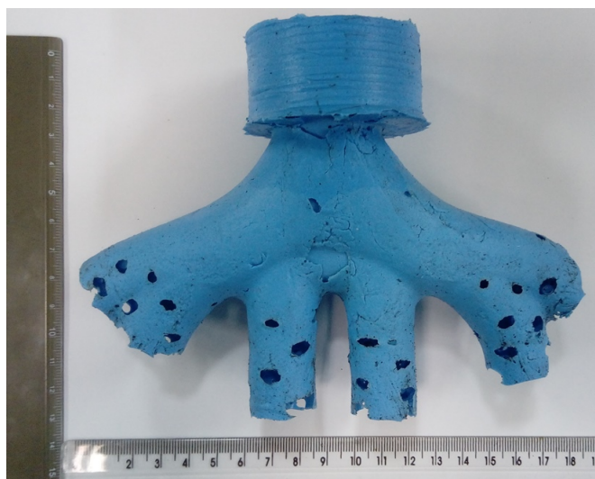
Figura 27 – Molde do pÓrtico de exaustão obtido por meio da tÓcnica de moldagem com silicone.
