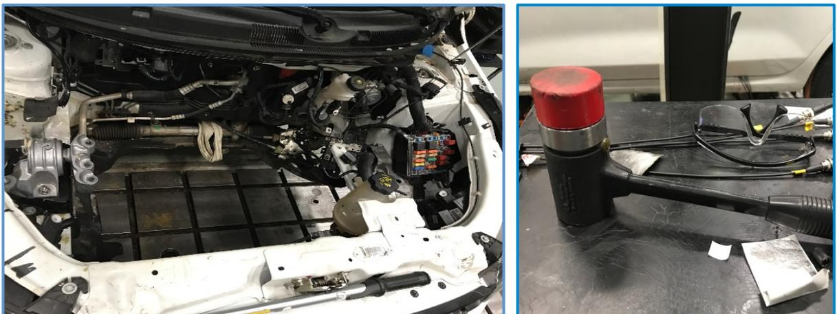
FIGURA 4.7 – Motor retirado para medição FRF e martelo de impacto
