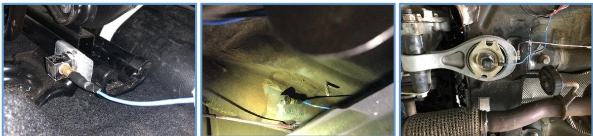
FIGURA 4.3 - Instrumentação dos acelerômetros
