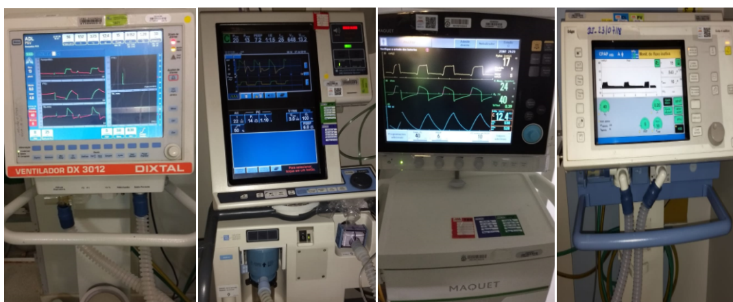
Figura 3: Exemplos de Ventiladores Mecânicos microprocessados presentes da Unidade.
