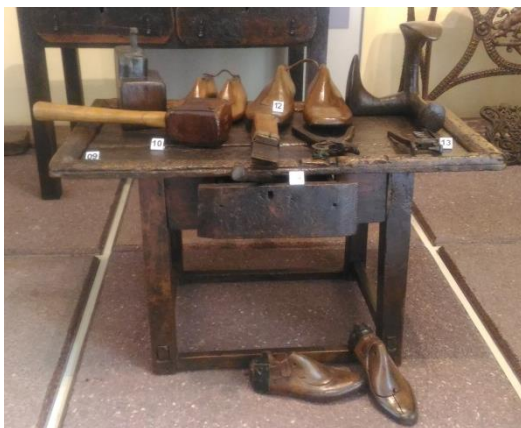
Figura 1: Banca de sapateiro com ferramentas, suporte e moldes do ofício de sapateiro
