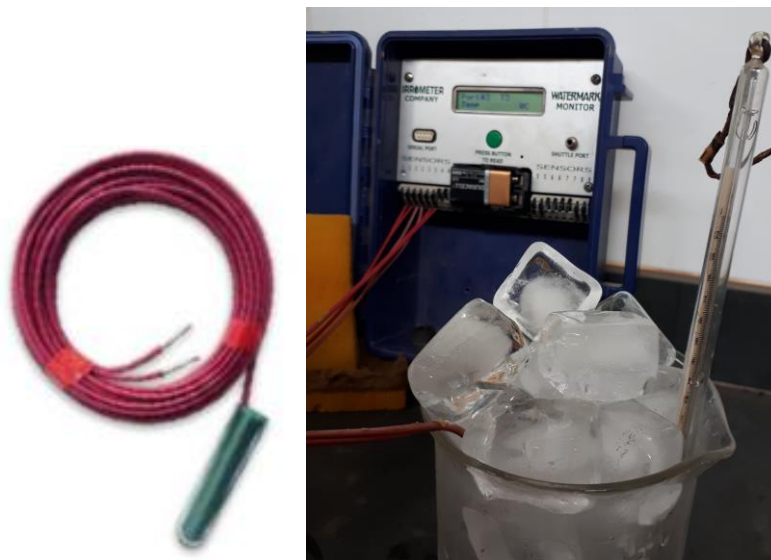
Figura 36 – Sensor de temperatura 200TS, modelo da Irrrometer compatível com o Watermark Monitor 900M e o momento da aferição de sua calibração.
