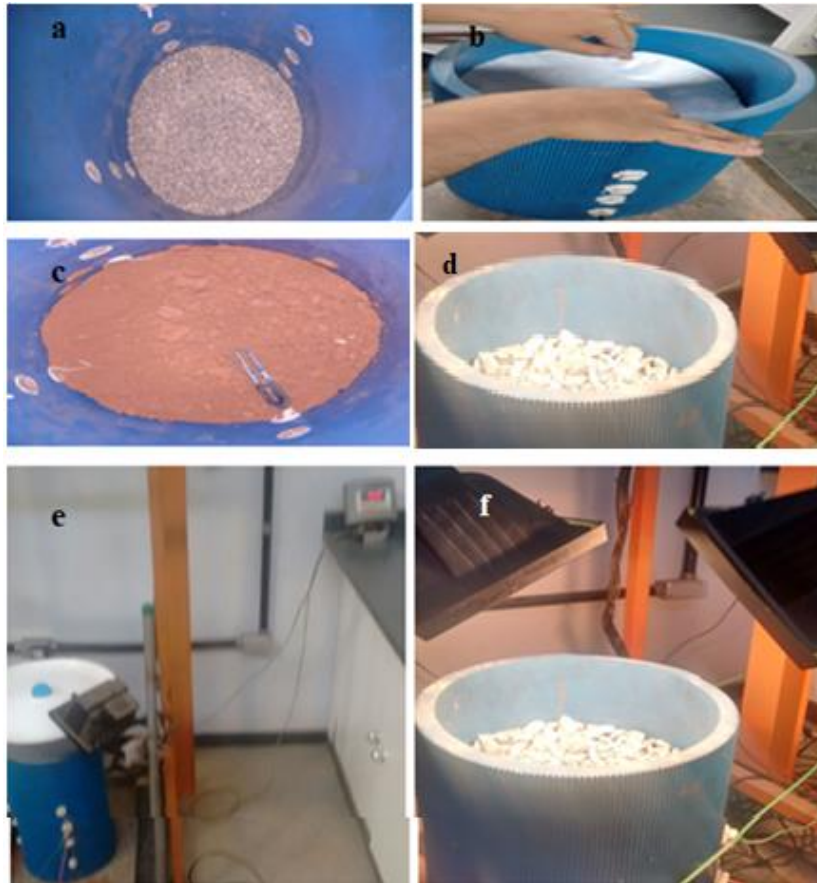
Figura 37 – Coluna de umedecimento e secagem, suas etapas construtivas e trajetórias. a) Colocação do pedrisco; b) Colocação do GTN; c) Solo compactado e escarificado e a inserção do sensor EC-5; d) Colocação da camada de topo de brita zero; e) Ensaio em trajetória de umedecimento e f) Ensaio em trajetória de secagem em detalhe o posicionamento das lâmpadas halógenas.
