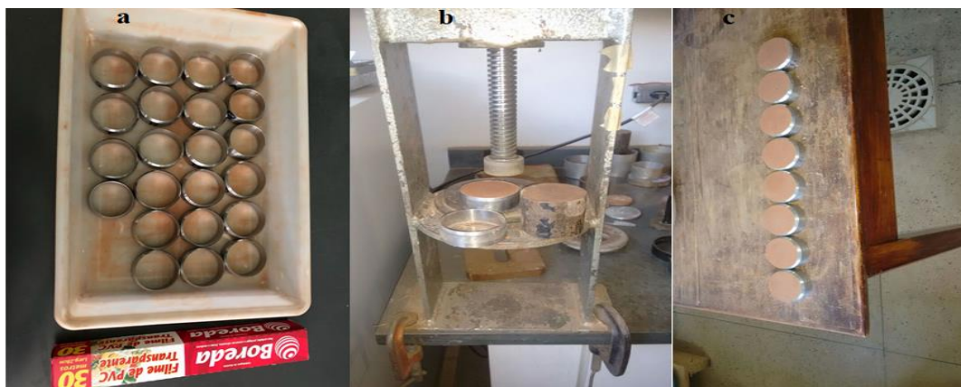
Figura 42 – Preparação do ensaio do papel filtro. a) Anéis metálicos. b) Compactação estática. c) Corpos de prova prontos.
