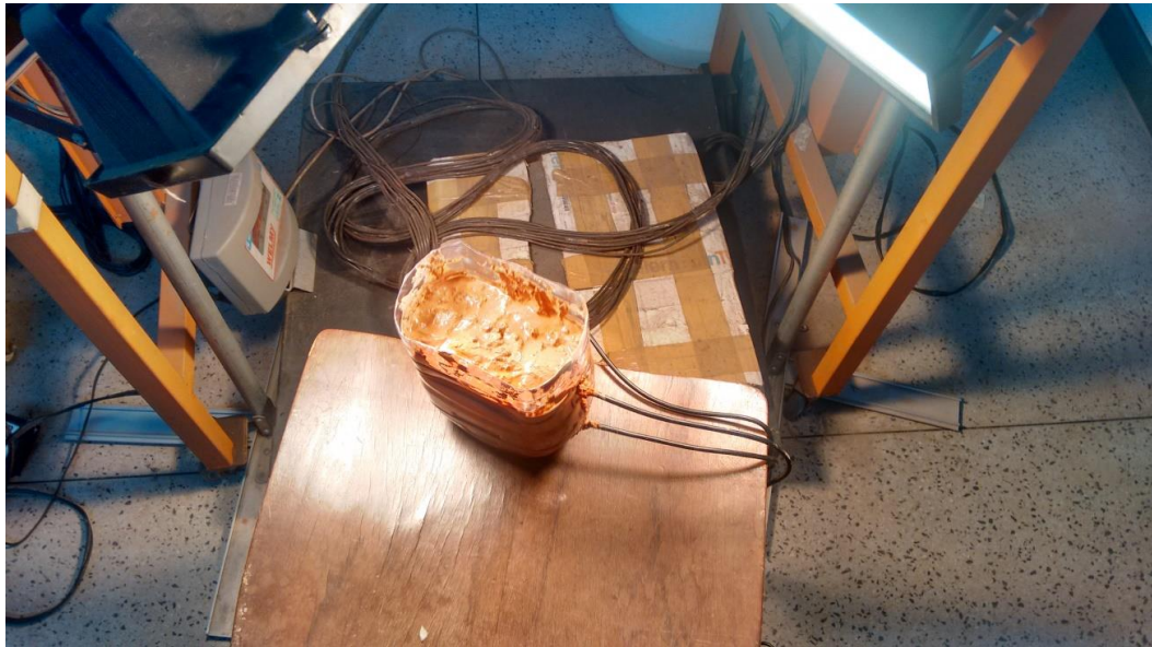
Figura 34 – Aferição da calibração do sensor de umidade EC-5 com incidência de luz halógena.
