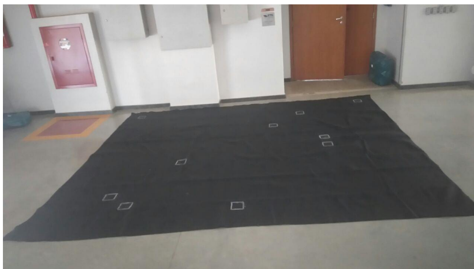
Figura 32 – Amostragem na manta de geotêxtil não tecido para a realização dos ensaios de gramatura e espessura.
