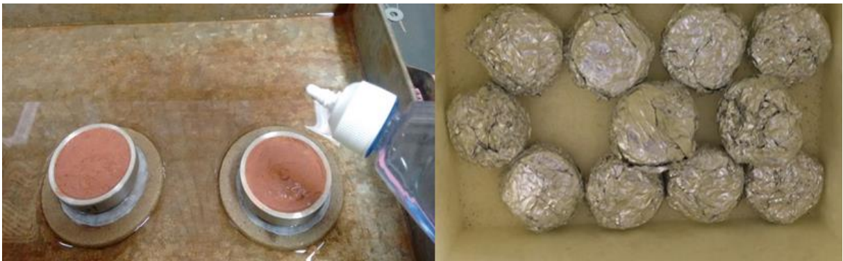
Figura 43 – À esquerda, saturação dos corpos de prova segundo duas frentes. À direita, ensaio na etapa de equalização do solo com o papel filtro envoltos por papel filme e papel alumínio.
