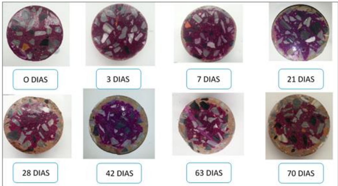
Figura 4.6 - Evolução da profundidade de carbonatação em função do tempo nos CPARs
