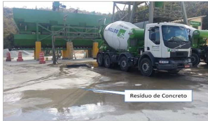
Figura 3.2 - Resíduo proveniente da lavagem dos caminhões
