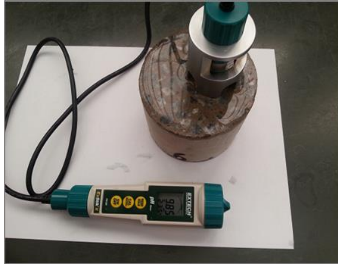
Figura 3.17 - Medição do pH na face interna da amostra serrada
