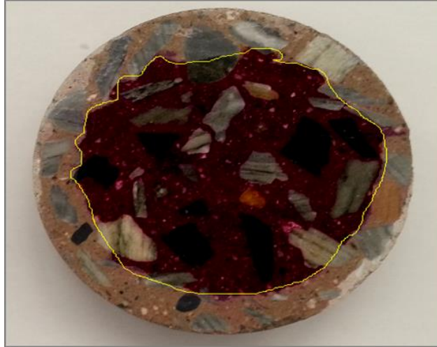
Figura 3.19 - Espessura carbonatada avaliada por meio de processamento de imagens
