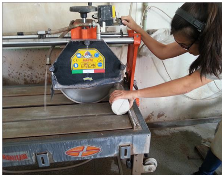
Figura 3.15 - Corte dos corpos de prova
