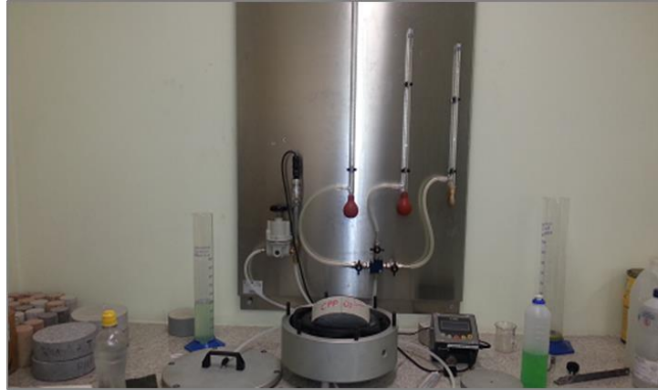
Figura 3.7 - Célula de alumínio do Equipamento Controls 58-E0031
