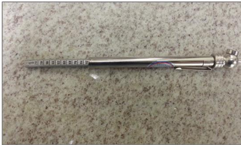
Figura 3.10 - Manômetro para conferência da pressão de ar
