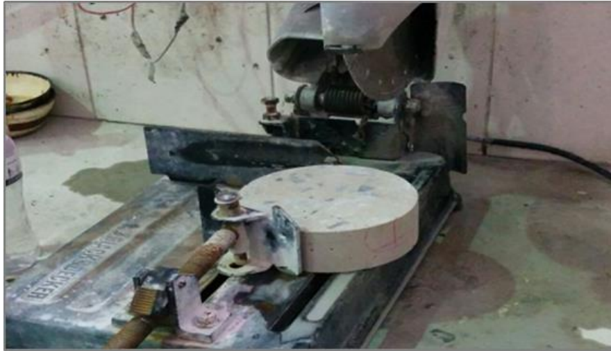
Figura 3.11 - Corte da amostra para o ensaio de porosimetria de mercúrio
