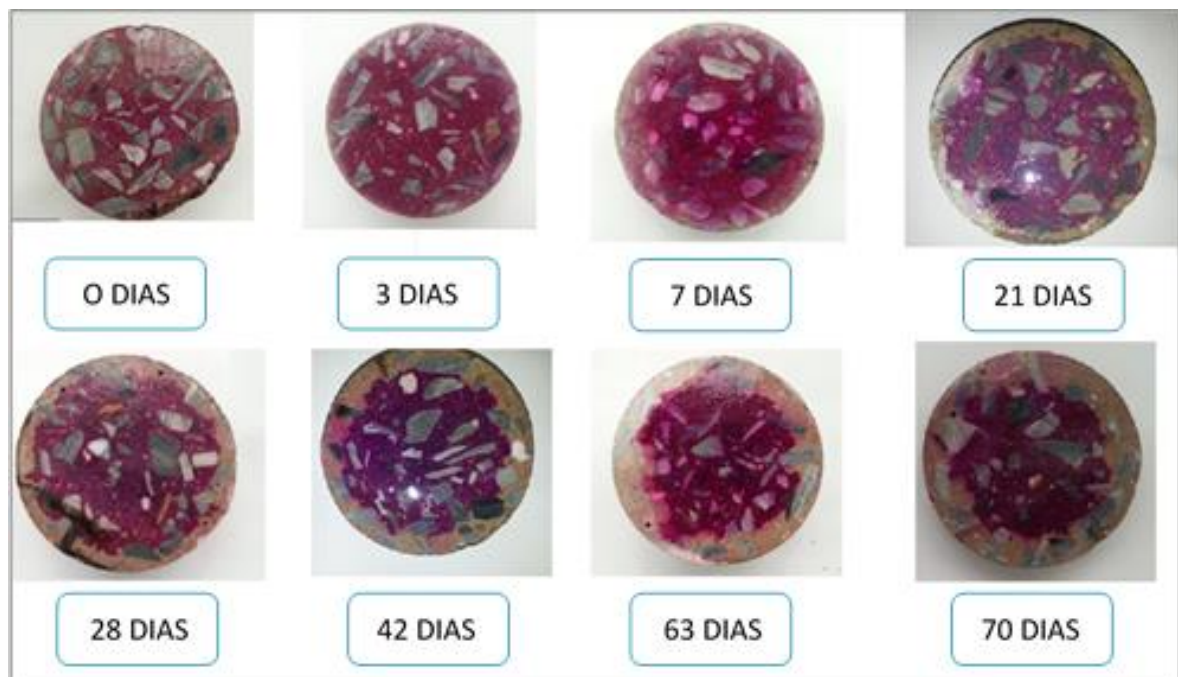
Figura 4.5 - Evolução da profundidade de carbonatação em função do tempo nos CPPs
