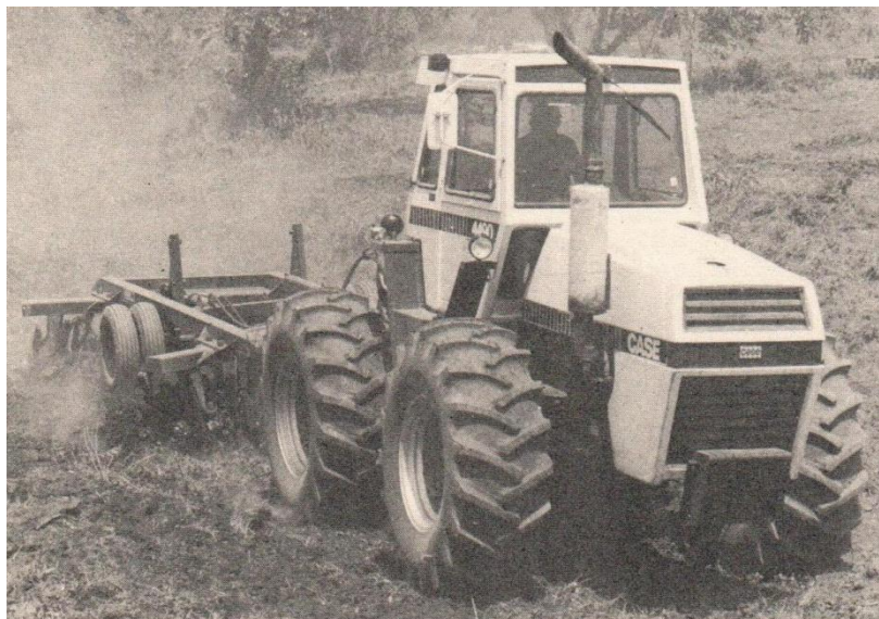
Figura 17- Trator, o Case 4490 CV, direção nas 4 rodas, pode trabalhar com rodado (8 rodas), tem tração nas 4 rodas e cabine com banco estofado, ar refrigerado etc.
