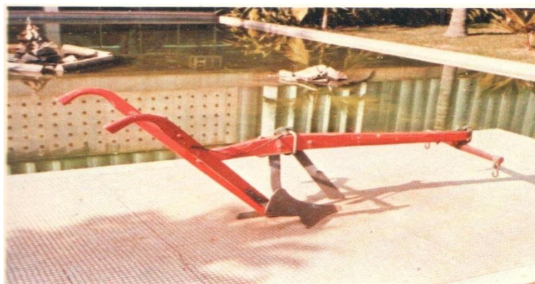
Figura 14- Arado de rabiça: arado de aiveca fixa de tração animal, por Galet, 1981
