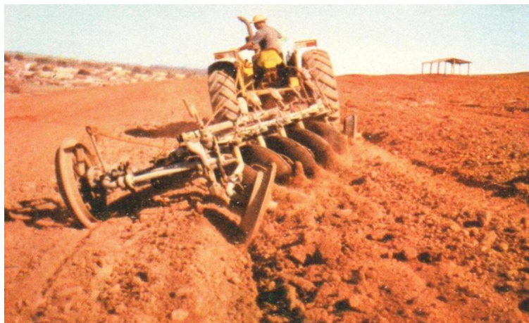
Figura 16- Arado de arrasto, com engate na barra de tração do trator. Os arados de discos montados, acoplados ou de levantamento hidráulico são os mais comuns
