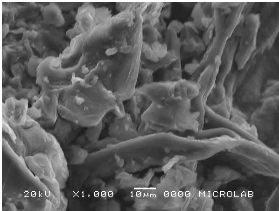
Figura II 1: Microfotografia de FP1 (farinha de mesocarpo + exocarpo + branqueamento), com amplitude de 1000 x e tensão de 20 kV.
