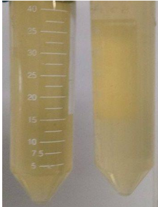
Figura 24 – Extratos obtidos das amostras CS2 e CS2b, respectivamente, para quantificação de fenólicos extraíveis.
