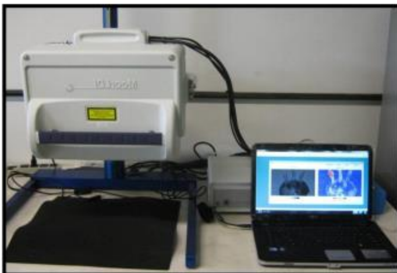
Figura 11- Equipamento de imagem de perfusão por laser Doppler (MoorLDPI-2, Inglaterra). Laboratório de Angiogênese e Células Tronco/UFMG.
