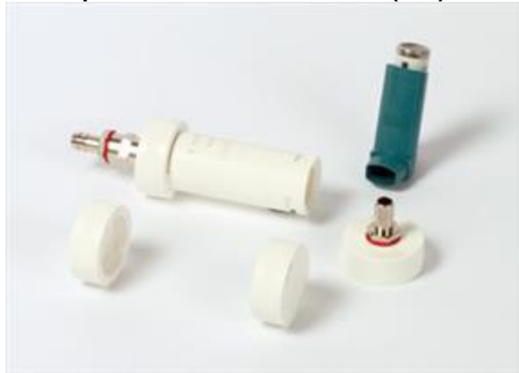
Figura 5 - Aparelho Dosage Unit Sampling Apparatus for Metered-Dose Inhaler (DUSA-MDI) utilizado para o teste de performance Uniformidade de Dose Liberada (UDL) para inalatório pressurizado dosimetrado (IPD).
