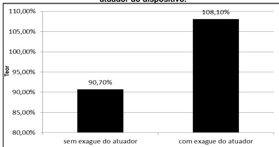
Figura 26 – Histograma de teor de SS IPD para o produto Aerofrin ® sem e com enxague do atuador do dispositivo.
