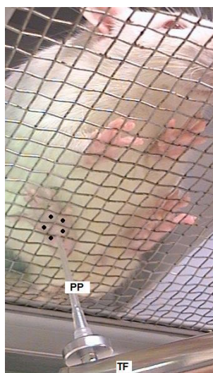
Figura 7 – Aparato utilizado para a avaliação da alodínia mecânica. PP - ponteira de polietileno; TF - transdutor de força. O sítio de estimulação é o centro delimitado pelos pontos pretos.
