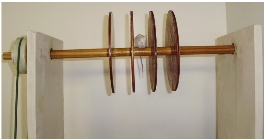
Figura 12 – Haste girante utilizada para avaliar a atividade motora de camundongos.
