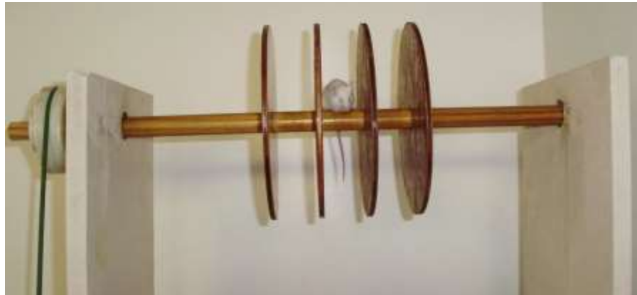
Figura 17 - Haste girante utilizada para avaliar a atividade motora de camundongos.
