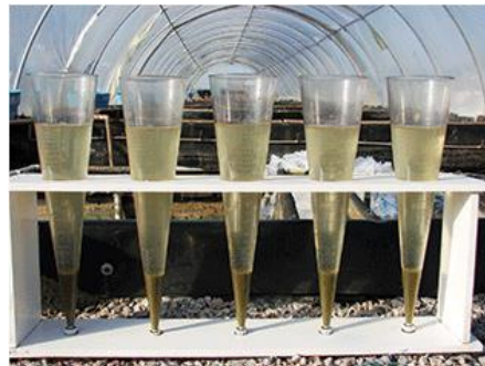
Figura A3. Cone de Imhoff - medição de sólidos suspensos
