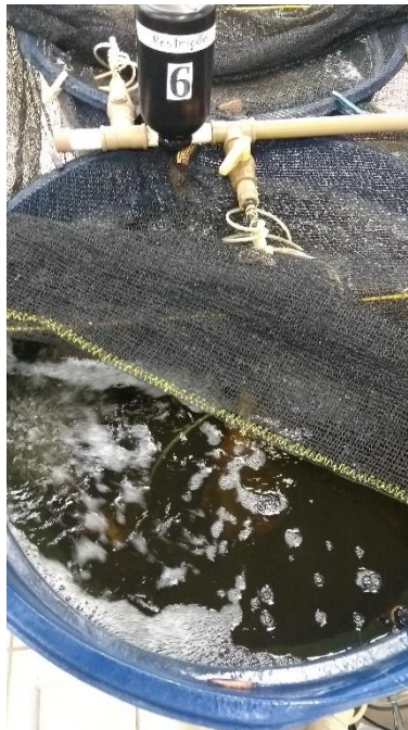
Figura 2. Sistema de aeração com difusores de ar.
