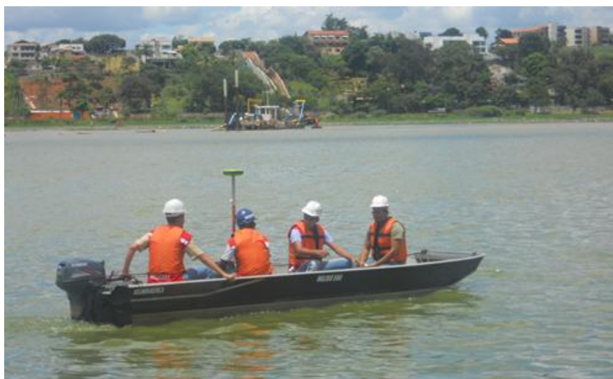
Figura 43: Levantamento Batimétrico no reservatório da Pampulha
