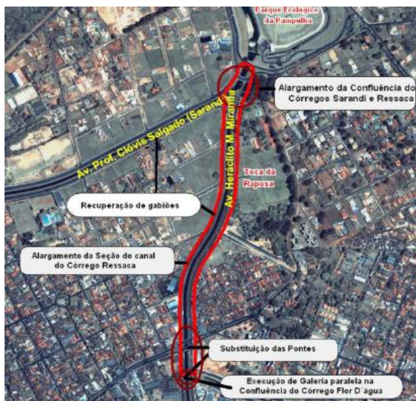
Figura 33: Localização das obras de tratamento de fundo de vale em execução no canal do Córrego Ressaca
