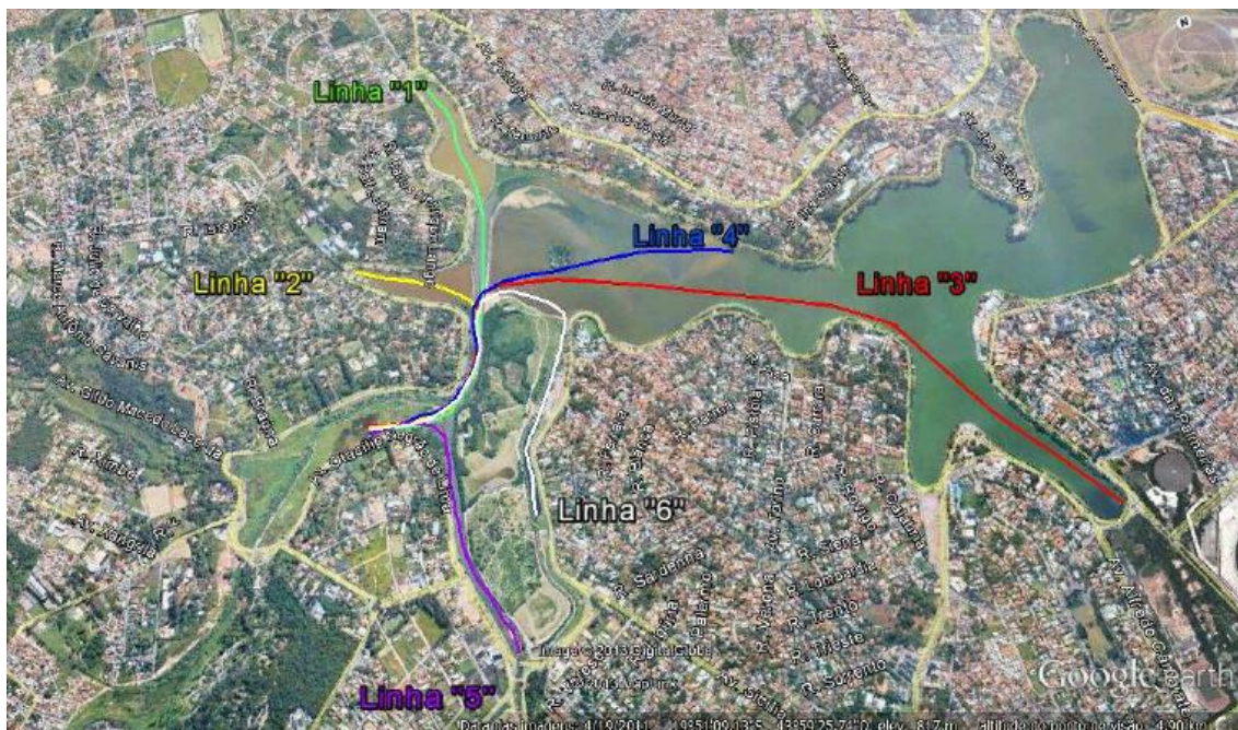
Figura 36: Planejamento da locação das linhas de tubulações
