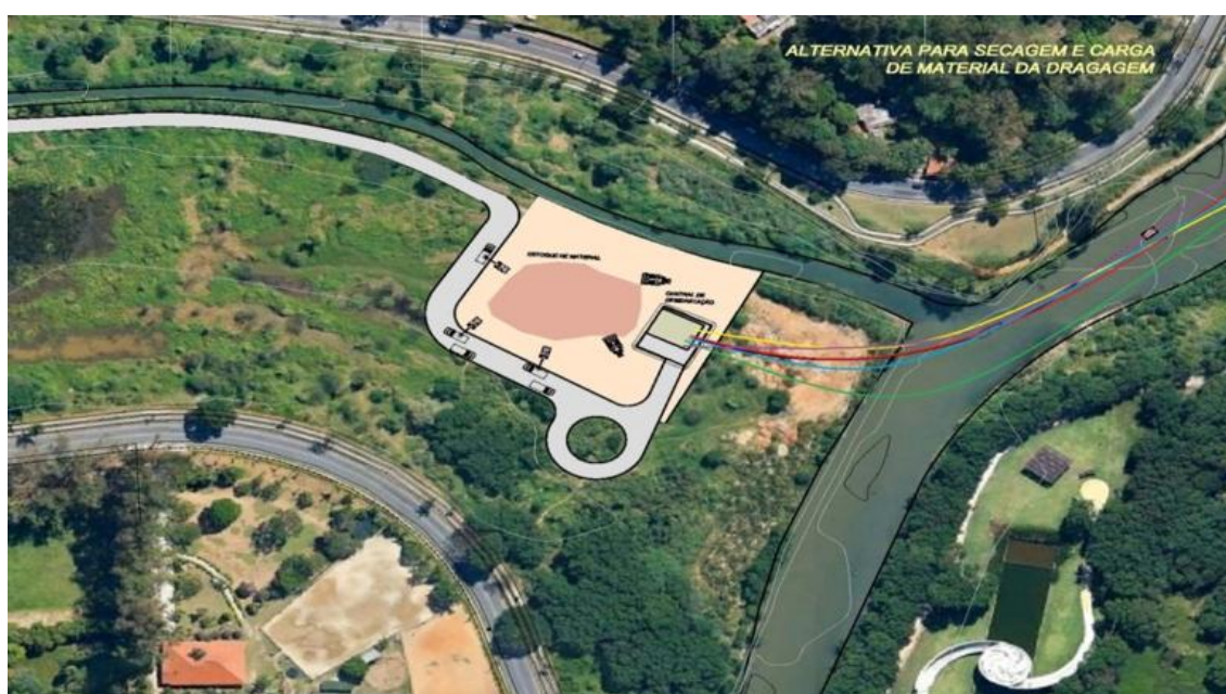
Figura 38: Pátio de desidratação e carga de sedimentos dragados
