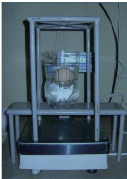
Figura 1. Equipamento utilizado para a análise do peso específico dos ovos.
