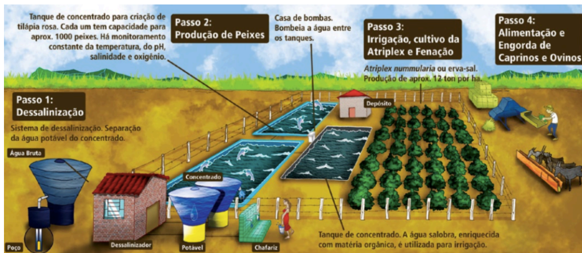
FIGURA 17: Sistema de dessalinização do Programa Água Doce
