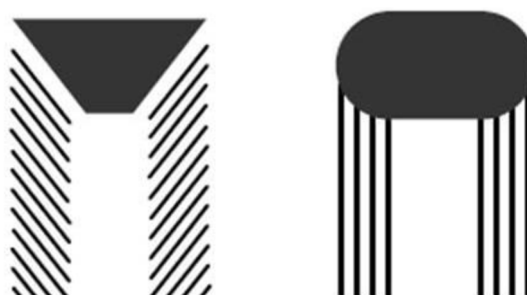
Figura 3.5 – Comparação esquemática entre a estrutura das NFC e NTC. Fonte: Adaptado Ludvig (2012).
