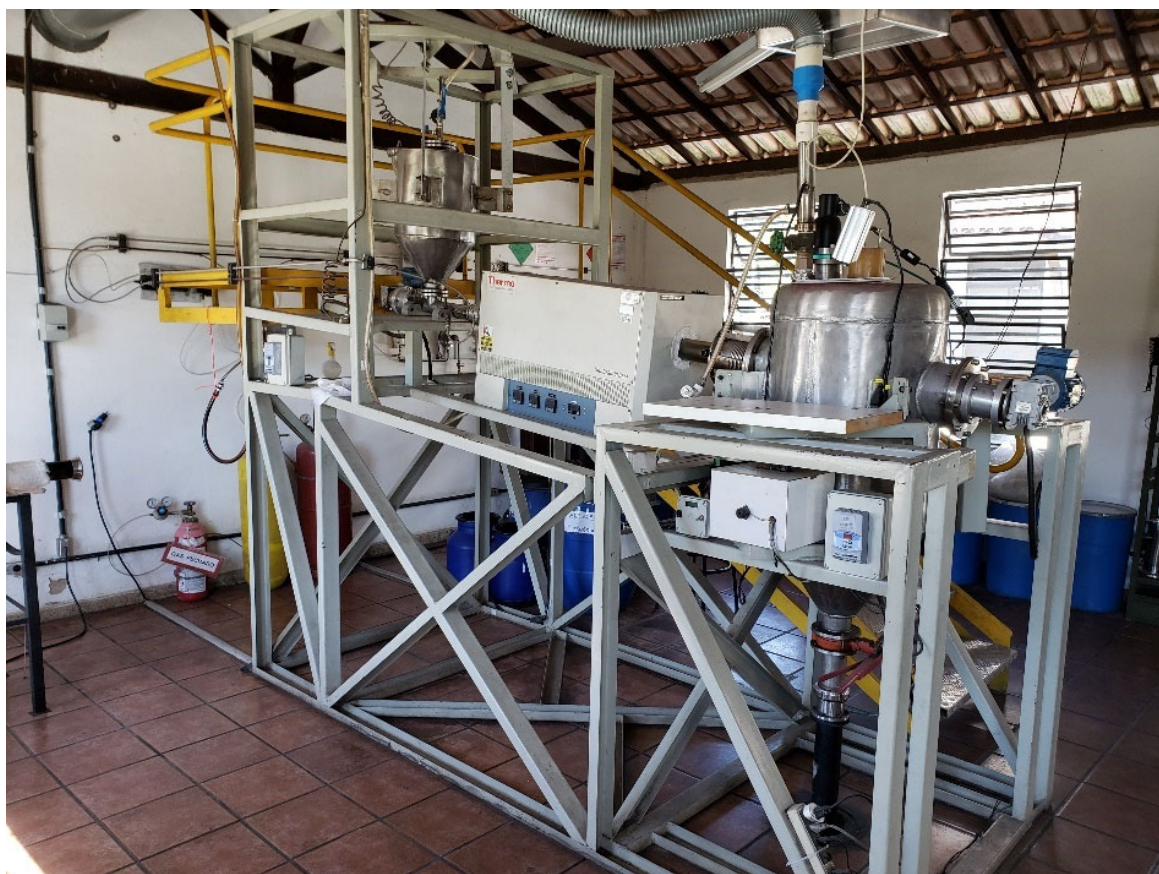
Figura 4.1 – Reator rotativo utilizado para sintetizar o clínquer nanoestruturado.
