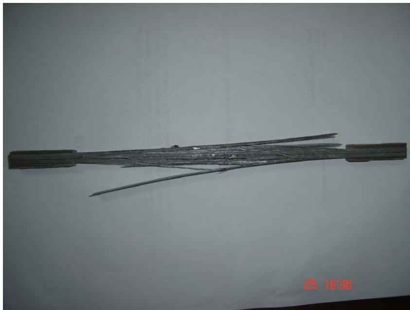
Figura 5.1 – CDP longitudinal após ensaio de tração
