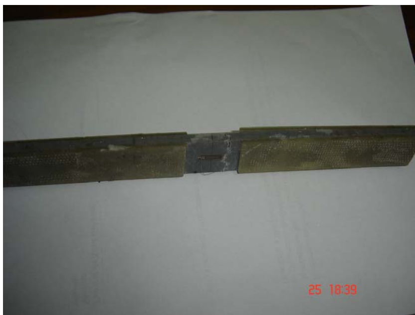
Figura 5.2 – CDP transversal após ensaio de tração
