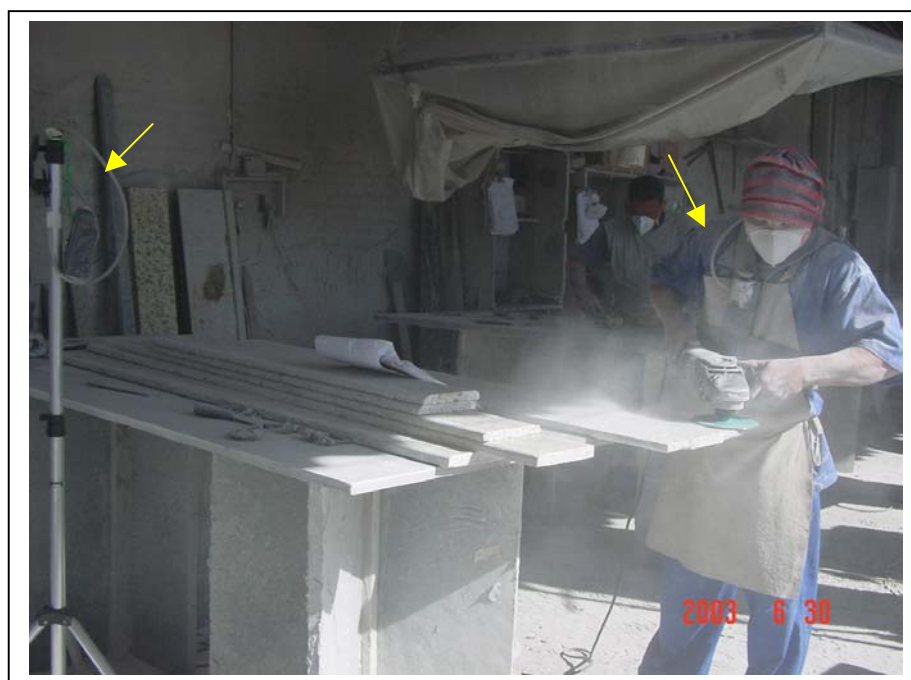
Figura 5.1: Trabalhador executando operação de acabamento em granito com disco de desbaste acoplado a lixadeira elétrica manual
