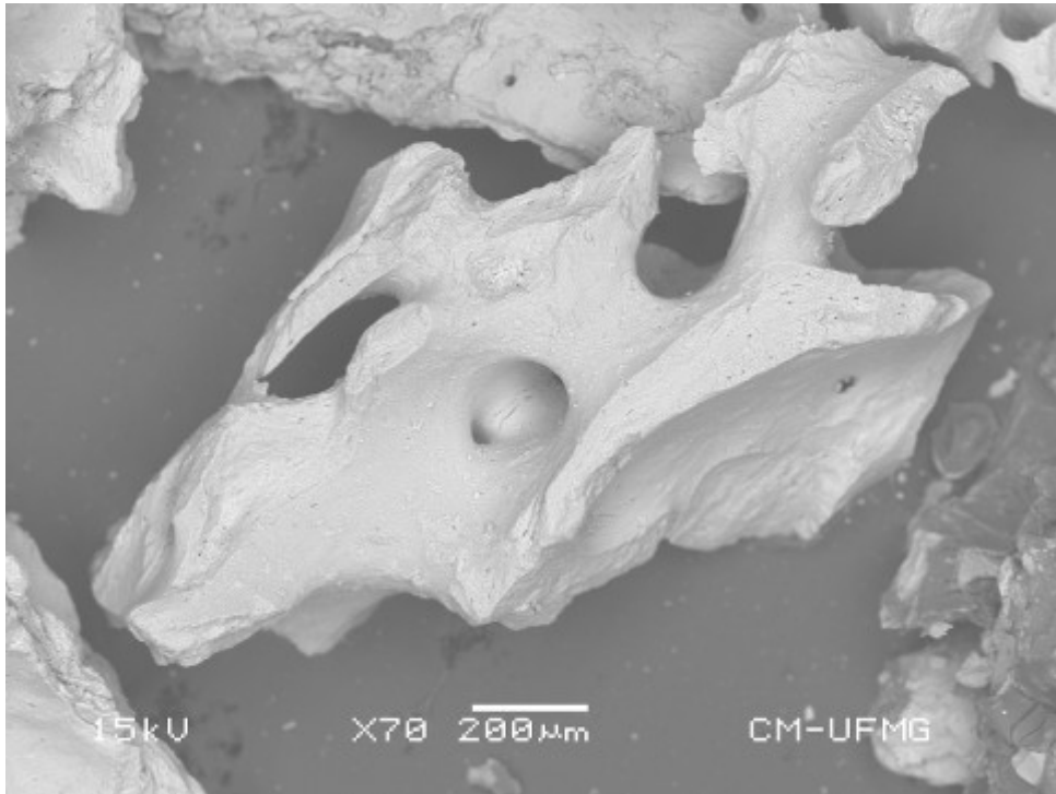
Figura 4.7: Microfotografia obtida por imagens de elétrons retroespalhados com aumento de 70 vezes do carvão de osso granular mostrando detalhes de porosidade
