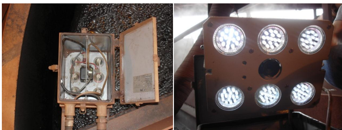
Figura 4-2: Câmera JAI TMC-1405GE instalada sobre a coluna de flotação e o detalhe da iluminação
