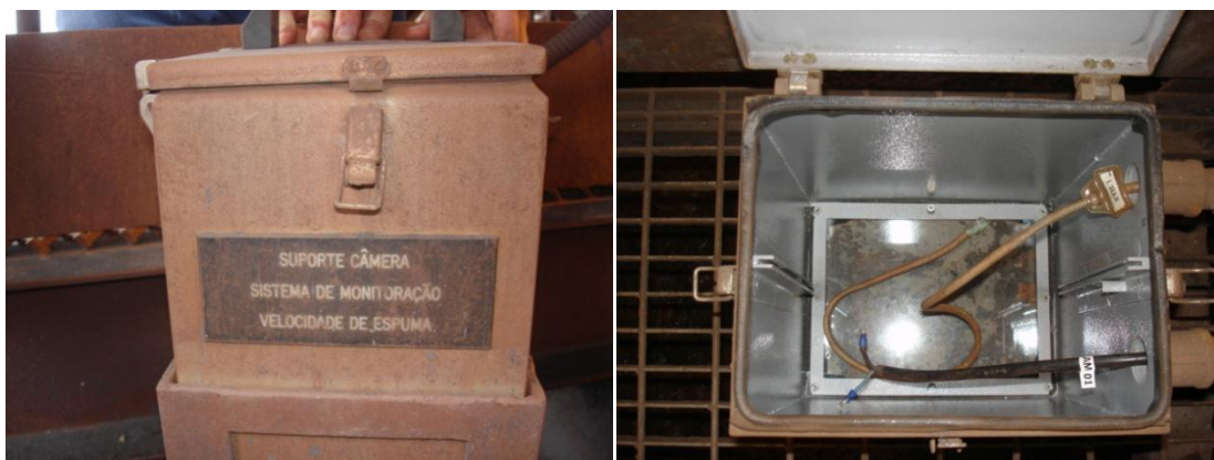
Figura 4-3: Caixa de condicionamento da câmera e uma foto do vidro da caixa com material da espuma projetado no fundo.
