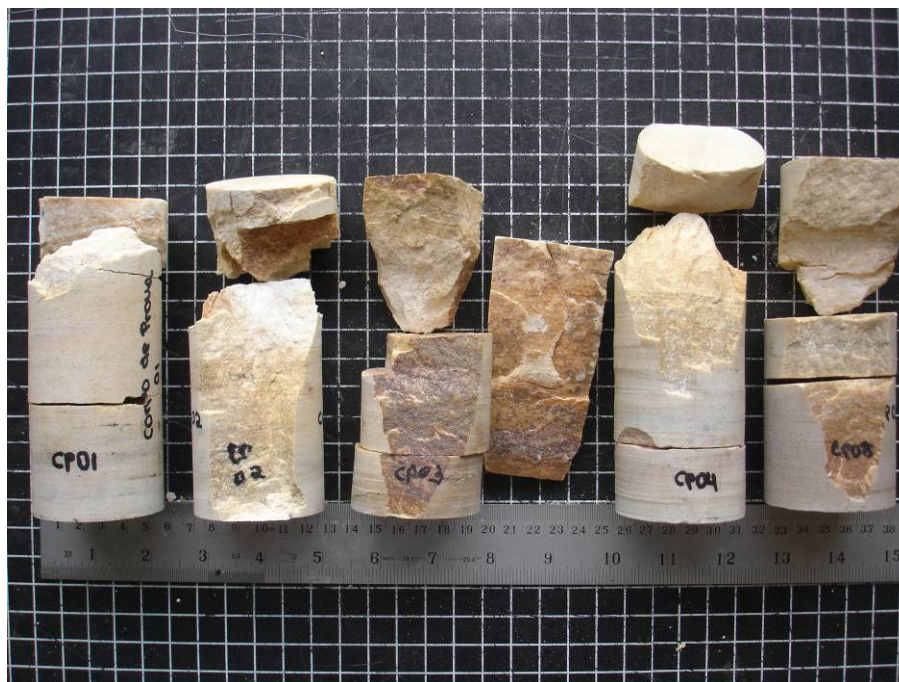
Figura 5.8: Corpos de prova rompidos durante o ensaio de resistência à compressão uniaxial
