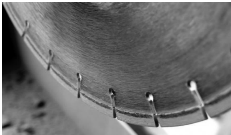
Figura 3.28: Disco diamantado segmentado (ROBLEDA et al. , 2010)
