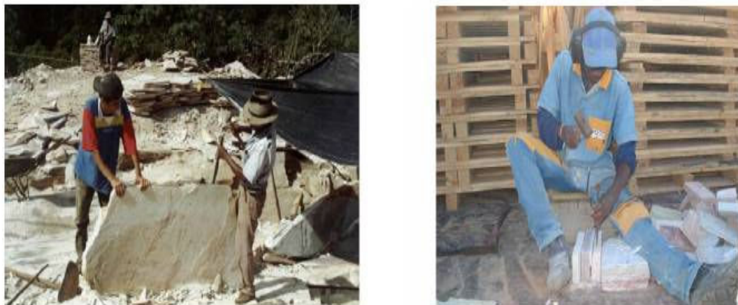
Figura 3.26: Extração manual aproveitando-se os planos de fratura do quartzito, usando-se cunha e marreta (esquerda), desdobramento do quartzito (direita) (PIRES, 2007)
