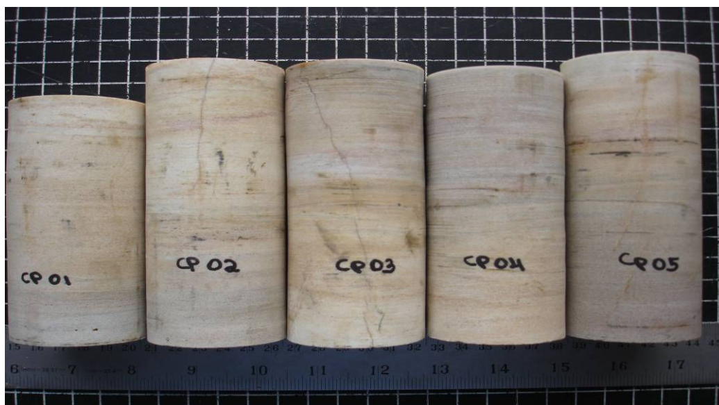
Figura 4.2: Corpos de prova de quartzito utilizados no teste de compressão uniaxial
