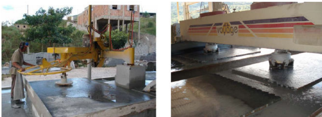
Figura 3.27: Polimento de quartzito extraído em Ouro Preto/MG. À esquerda, máquina de polimento manual e à direita, polimento automático (PIRES, 2007)
