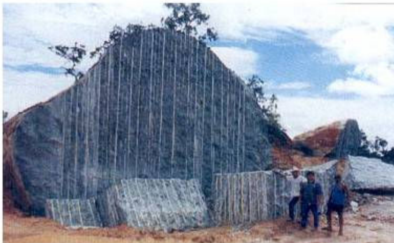
Figura 3.20: Corte de matação efetuado com argamassa expansiva – Piranhas/GO. (REGADAS, 2006)
