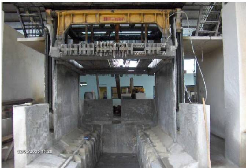
Figura 3.24: Tear multi-lâminas utilizado no corte de rochas ornamentais (COIMBRA FILHO, 2006)
