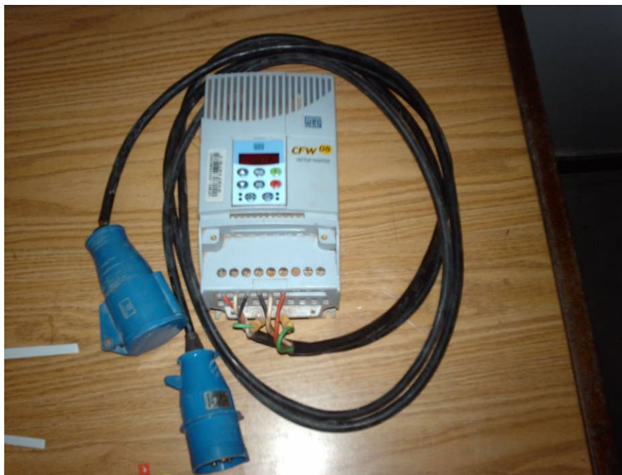
Figura 4.8: Inversor de frequência
