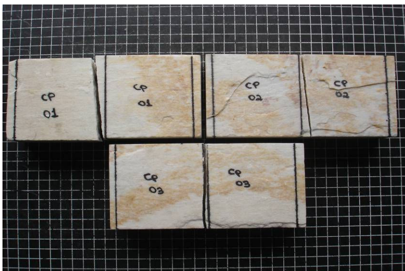
Figura 5.12: Corpos de prova rompidos após o ensaio de flexão – quartzito
