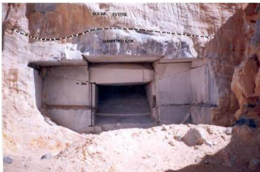
Figura 3.17: Início de lavra de quartzito azul imperial, executada com fio diamantado Oliveira dos Brejinhos/BA (da MATTA, 2003)
