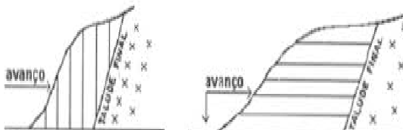
Figura 3.12: Seções esquemáticas da lavra por tombamento, em fatias verticais (à esquerda) e em fatias horizontais (à direita) ( CHIODI FILHO, 1995)
