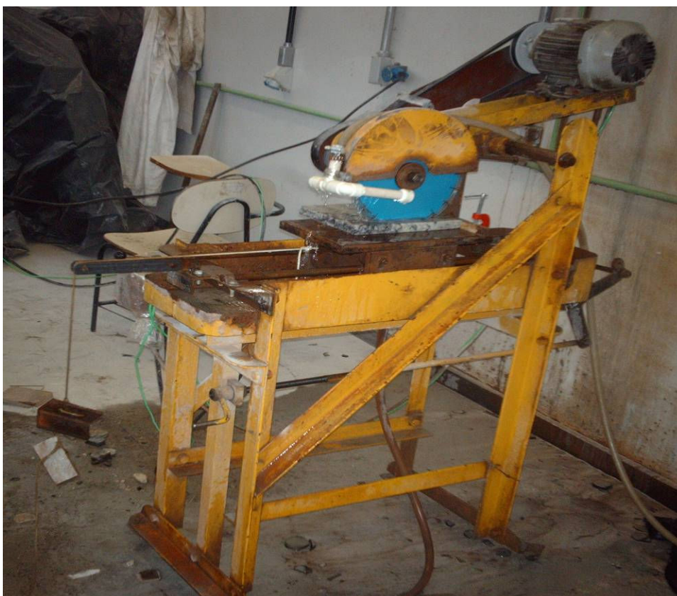
Figura 4.7: Serra diamantada (Laboratório de Tecnologia de Rochas – Escola de Engenharia/UFMG)
