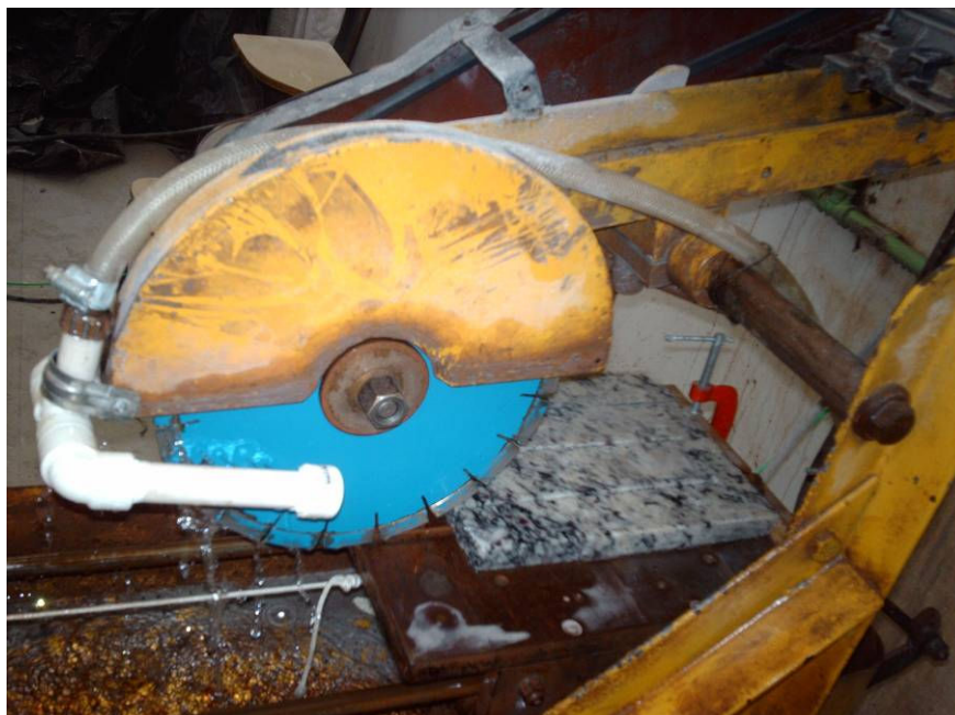
Figura 4.10: Corte de uma amostra de granito
