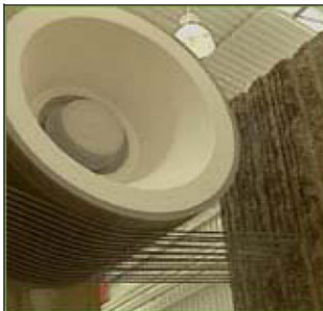
Figura 3.25: Tear multifios diamantados para o corte de granito (RIBEIRO, 2005)
