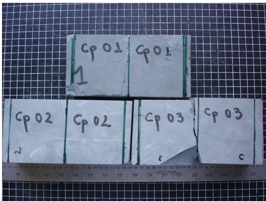
Figura 5.15: Corpos de prova rompidos após o ensaio de flexão – ardósia
