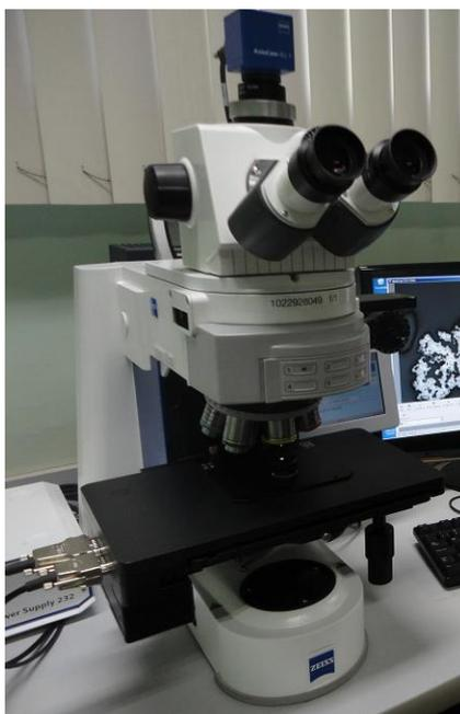
**FIGURA 4.3** – Foto do microscópio ótico de luz refletida e da câmera digital da marca Zeiss.
