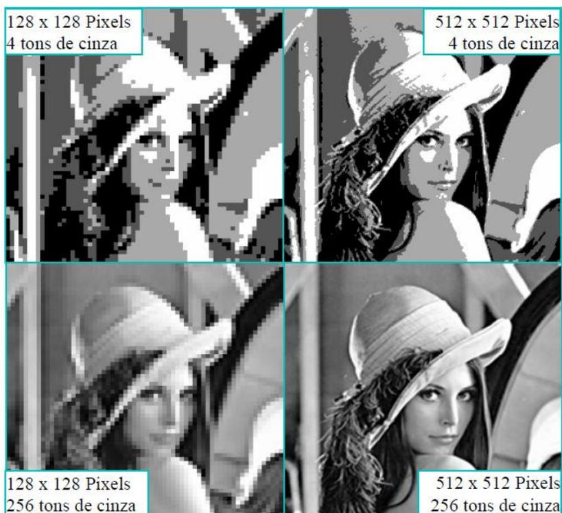
**FIGURA 3.16** – Quatro figuras representando a variação da resolução e quantização de uma imagem digital.
