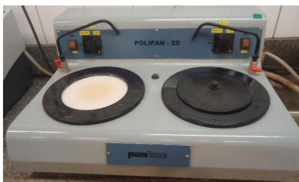
**FIGURA 4.2** – Foto do equipamento de polimento.
