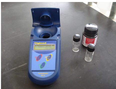
Figura 4.7: Turbidímetro Digimed modelo DM-TU.
