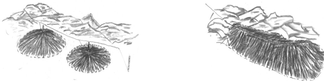
Figuras 3.31: Disposições típicas para o sistema "pastefill". (Robinsky, 2002)
