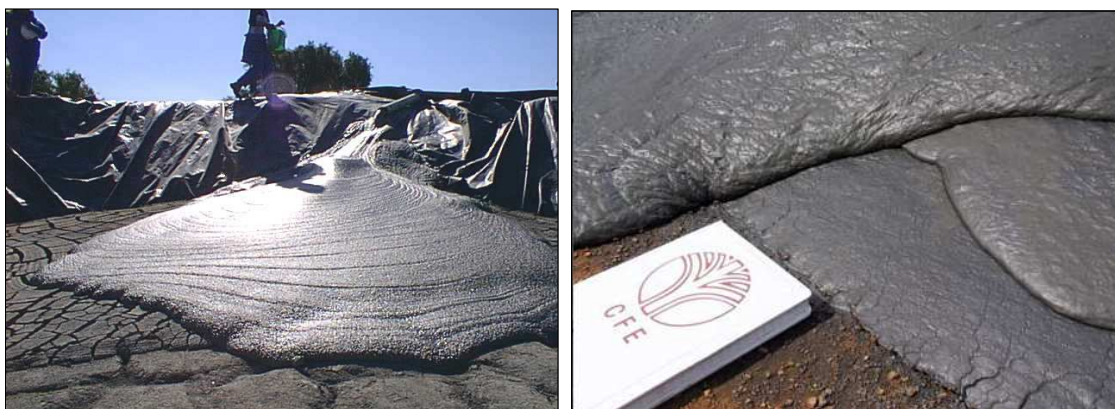
Figura 3.13: Disposição de pasta de rejeitos em uma e três camadas na indústria mineira da Tanzania. (Theriault, 2001)
