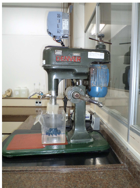
Figura 4.8: Célula de Flotação de Laboratório Denver.
