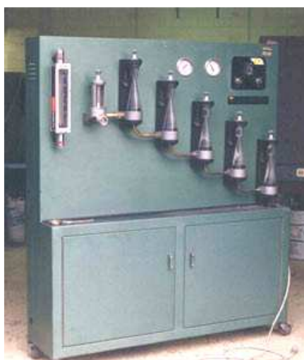
Figura 4.2: Cyclosizer Warman (à esquerda) e granulômetro Sympatec de Laboratório (à direita). ( www.weirminerals.com )-( www.extronex.com )
