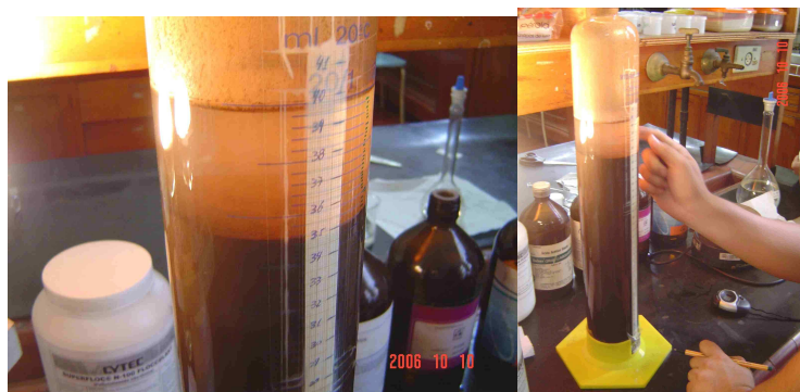
Figura 4.6: Sedimentação descontínua com lama calcária em provetas de 2.000ml.
