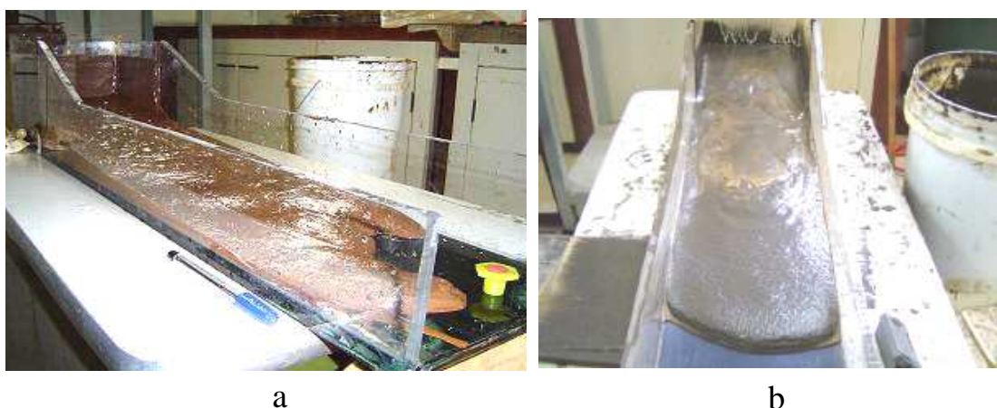
Figura 4.15: Fotografias da calha construída em acrílico: a) isométrica; b) superior.
