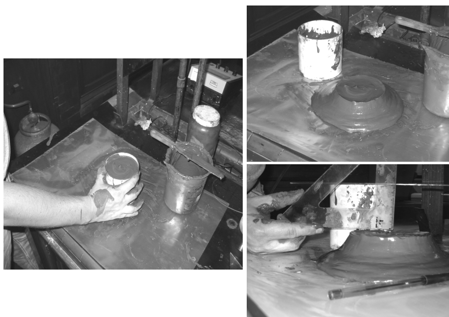
Figura 4.16: Testes de cilindro "slump" feitos para uma pasta mineral.
