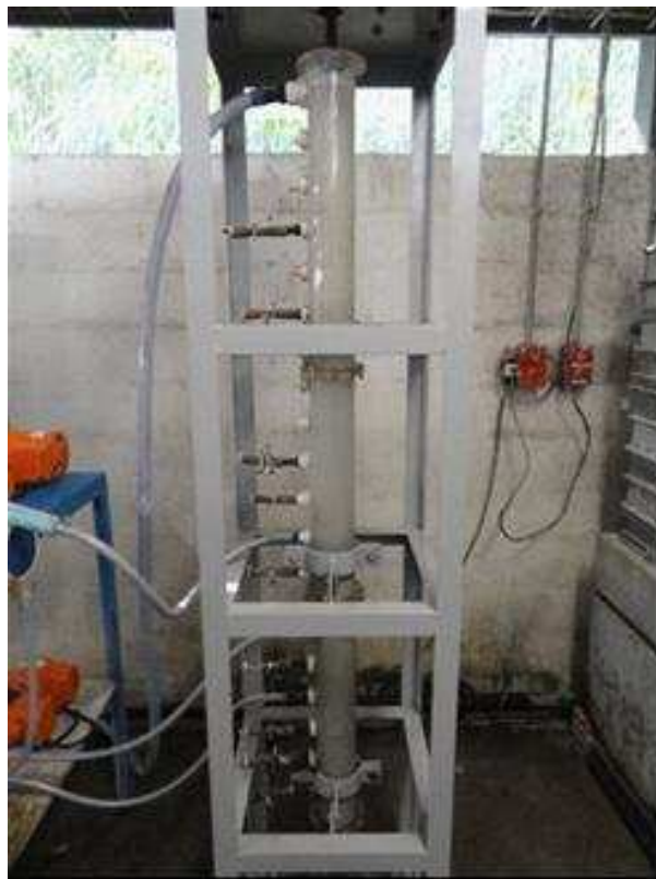
Figura 4.10: Espessador em escala de laboratório para produção de pasta mineral.
