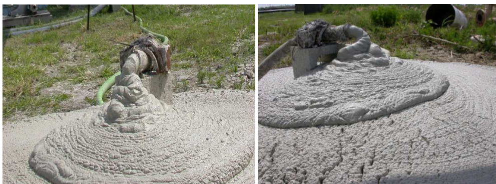
Figura 3.12: Sistema de disposição superficial de pasta mineral desde argilas fosfáticas. (D.Tão et al, 2008)
