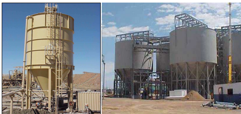
Figura 3.4: Espessadores de alta densidade de cone profundo. (Jewell, 2002)
