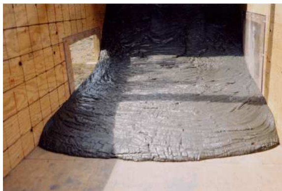
Figura 3.28: Teste de Flume para uma pasta com "slump" de 71,1mm. (Chambers et al., 2002)
