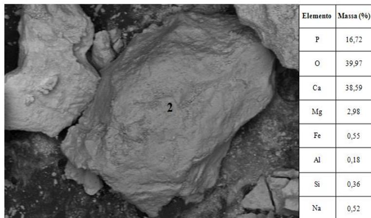
Figura 5.9 - Imagem da Partícula 2 da Subárea 2 obtida de elétrons retroespalhados, na tensão de 15kV e aumento de 100 vezes.
