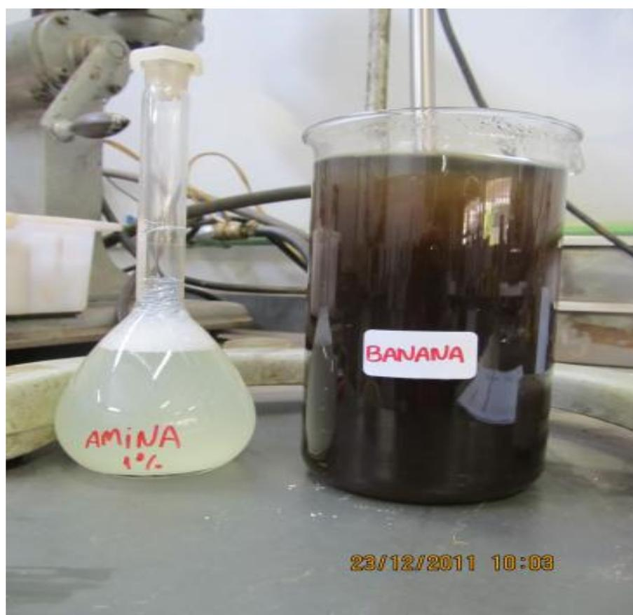
Figura 4.6 – Suspensão de amido de banana verde gelatinizado e solução de amina.
