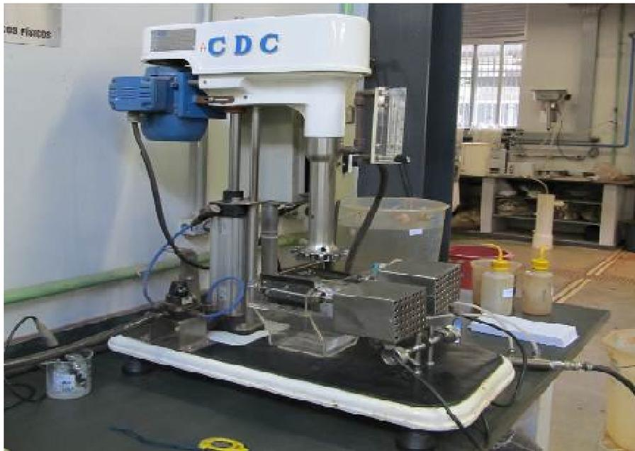
Figura 4.7 – Célula de flotação em bancada da CDC – Laboratório DEMIN/UFMG
