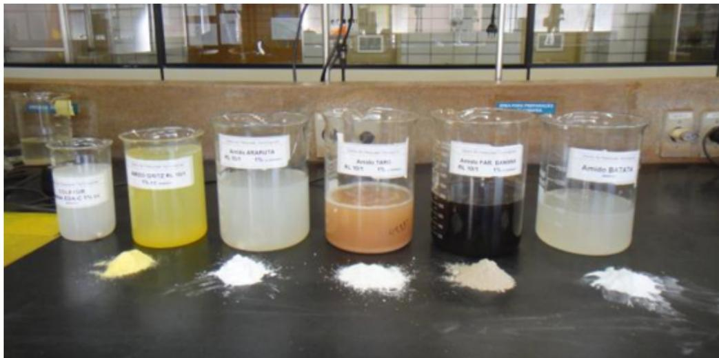
Figura 4.1 – Solução de amina e das suspensões de amido gelatinizadas, ambas a 1%.
