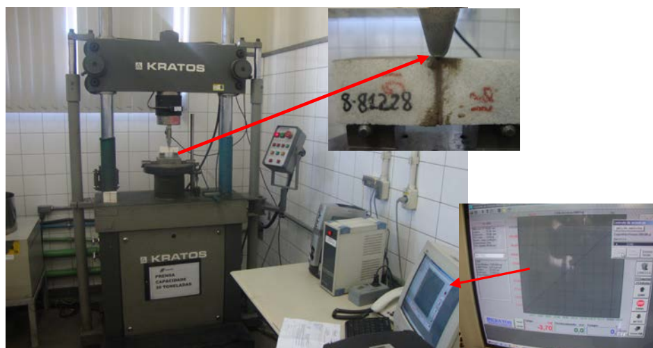
Figura 4.10: Determinação de força ligante segundo a ABNT NBR 8384.
