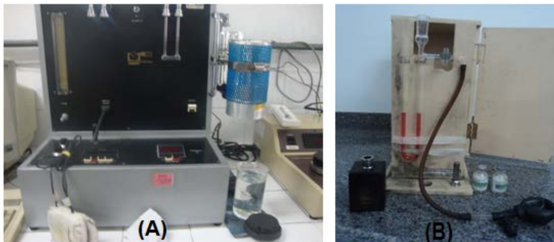
Figura 4.4: Equipamentos de determinação de área superficial específica (A) BET e (B) Blaine.
