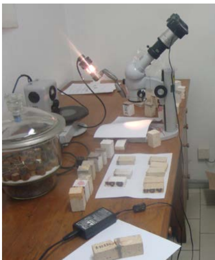
Figura 4.11: Lupa estereoscópica com amostras preparadas para análise de superfícies.
