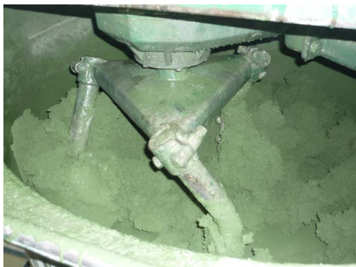
Figura 3.59 – Vista interna do misturador Eirich - mistura de plástico refratário.
