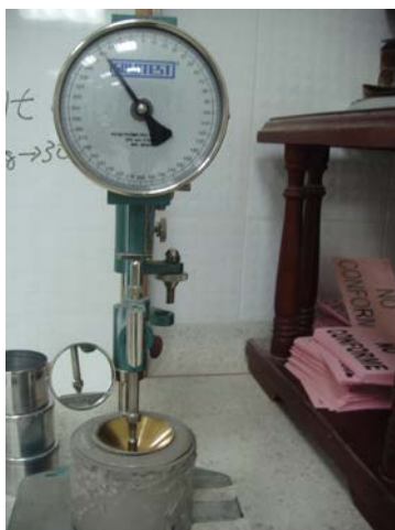
Figura 4.9: Determinação da consistência segundo a ABNT NBR 11508.
