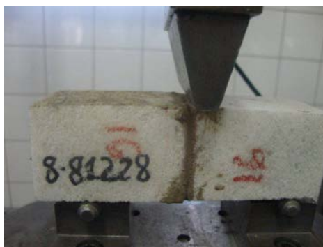
Figura 3.30: Posicionamento incorreto do corpo de prova sob o dispositivo de flexão
