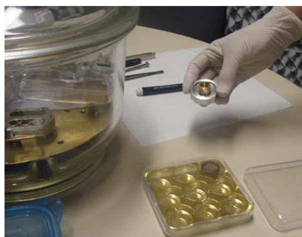
Figura 4.15: Detalhe da colocação do CP já metalizado no porta-amostras.
