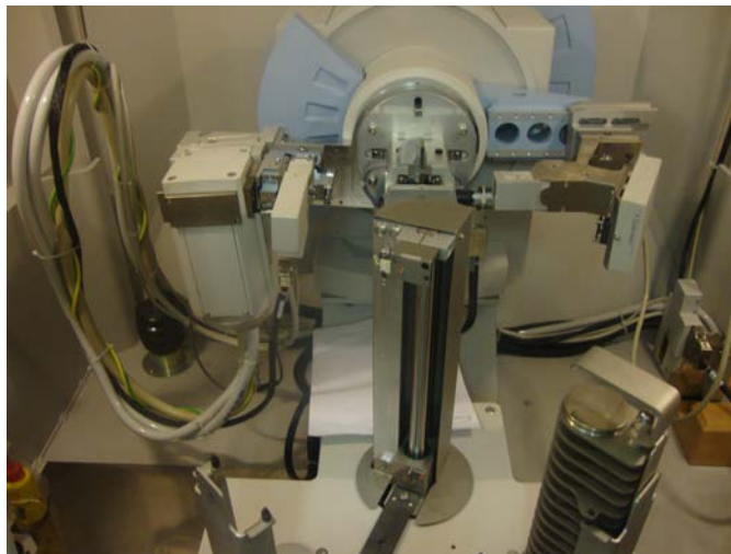
Figura 4.7: Difratorômetro de raios-X, marca PANalytical, modelo X'Pert PRO.
