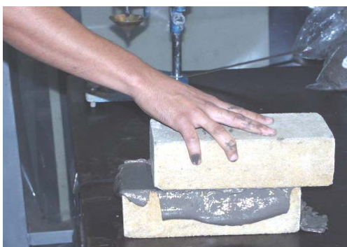
Figura 4.8: Determinação de tempo de retenção de água segundo a ABNT NBR 8827.
