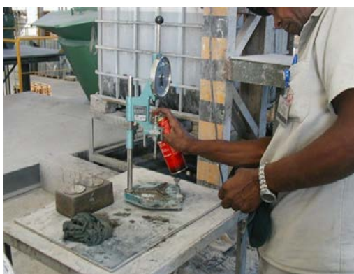
Figura 3.22 – Detalhe da lubrificação do penetrômetro antes de realizar o ensaio.
