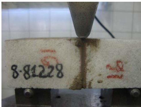
Figura 3.29: Posicionamento correto do corpo de prova sob o dispositivo de flexão
