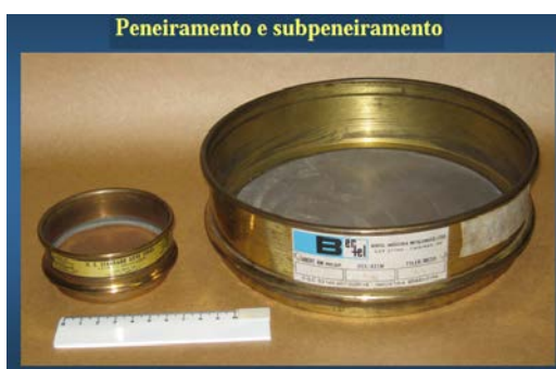
Figura 3.15 - Peneiras utilizadas para peneiramento e subpeneiramento, BRANDÃO (2007)
