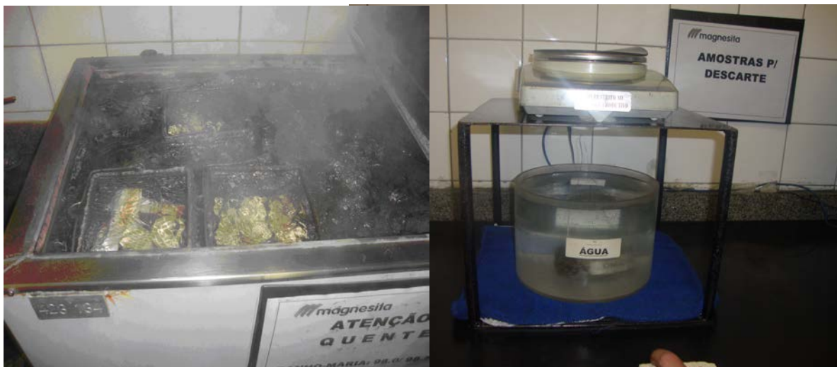
Figura 4.2: Processo de saturação de CPs para determinação da PA e balança hidrostática
