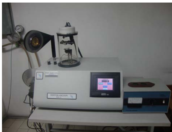
Figura: 4.13 – Aparelho utilizado para metalização das amostras.
