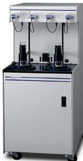
Figura 3.39: Porosímetro de intrusão de mercúrio: Micromeritics, modelo Autopore IV série 9500, Manual de operação Micromeritics, CPqD-MRSA.
