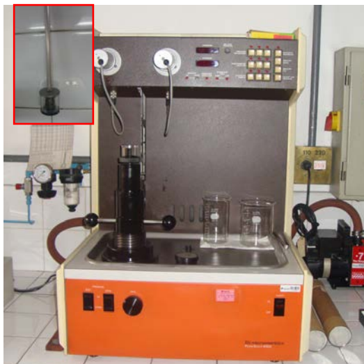
Figura 4.3: Porosímetro de mercúrio Micromeritics 9320 com detalhe acima à esquerda – penetrômetro n°5 utilizado no ensaio.
