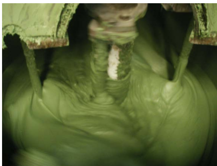
Figura 3.55 – Vista interna do misturador com hélices dispersoras em movimento.
