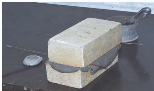
Figura 3.24 – Sobreposição dos tijolos separados por arames de 3mm.
