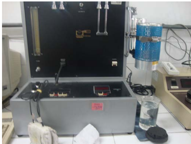
Figura 3.45: Equipamento Quantachrome para cálculo da área superficial por adsorção de N_2 .
