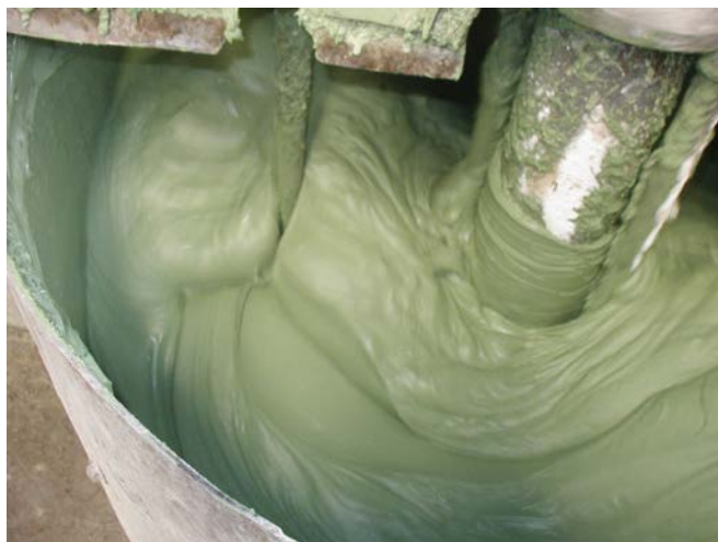
Figura 3.57 – Vista interna do misturador com hélices tipo facas em movimento.
