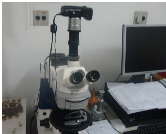
Figura 4.12 – Microscópio ótico de luz refletida marca Carl Zeiss modelo Imager A 1-m.
