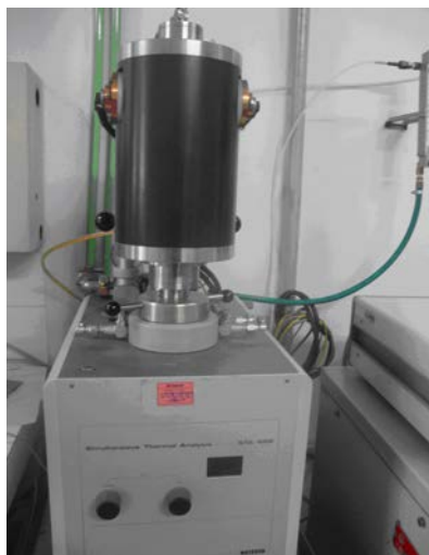
Figura 4.5: Aparelho Simultaneous Thermal Analysis, Netzsch, modelo STA 409.
