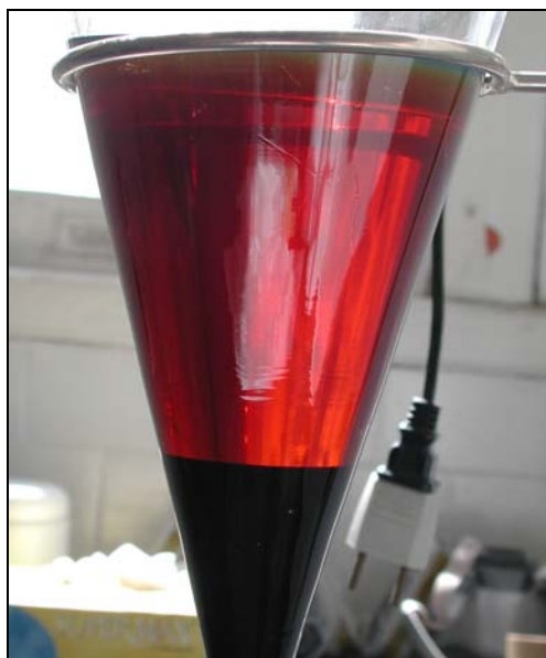
Figura 24: Separação de fases observada após transesterificação de óleo de grãos de café sadios na presença de catalisador básico.
