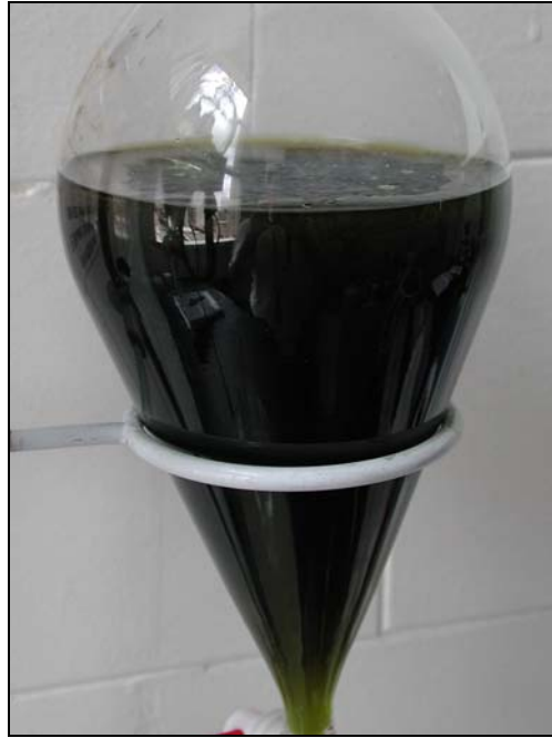
Figura 26: Produto da reação de transesterificação de óleo da mistura PVA na presença de catalisador básico.
