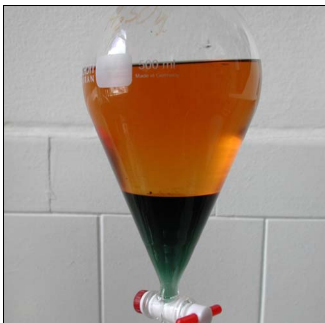
Figura 15: Separação de fases observada para a transesterificação do óleo de soja na presença de catalisador ácido.
