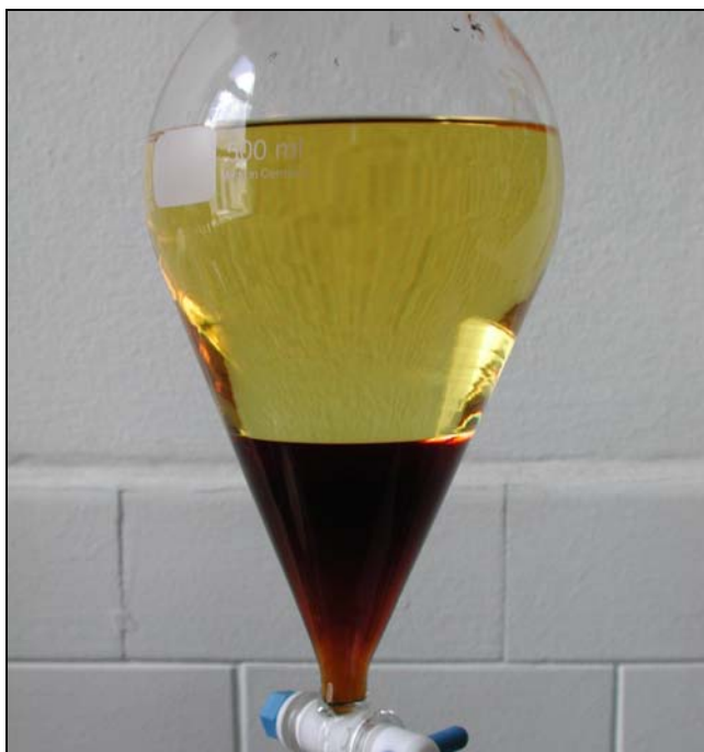
Figura 14: Separação de fases observada para a transesterificação do óleo de soja na presença de catalisador básico.
